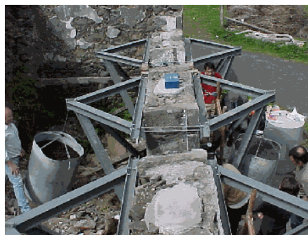
Fig. 4.7 – Sismógrafo colocado em cima da parede A2
