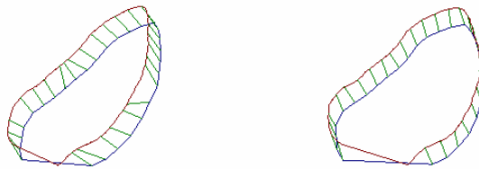
Figura 6.40: Emparelhamento dos contornos “ heart1 ” e “ heart5 ”. À esquerda usando apenas informação da distância ao centróide, à direita usando informação da distância ao centróide com ajuste local.
