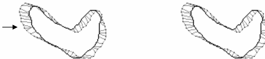
Figura 5.19: Emparelhamento dos contornos da Figura 5.18: à esquerda usando os algoritmos de afectação clássicos e à direita usando o algoritmo de programação dinâmica. (A seta representada indica um emparelhamento cruzado.)
