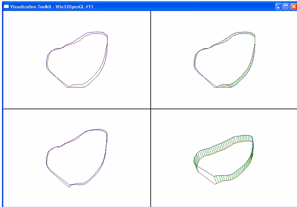
Figura 6.20: Emparelhamento baseado na distância ao centróide dos contornos “heart6” e “heart5”, definidos por 84 e 81 pontos, respectivamente.
