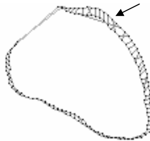
Figura 5.3: Emparelhamento dos contornos da Figura 5.2 com optimização global das correspondências usando o algoritmo Simplex para problemas de fluxo. (A seta representada assinala uma região de emparelhamentos cruzados.)
