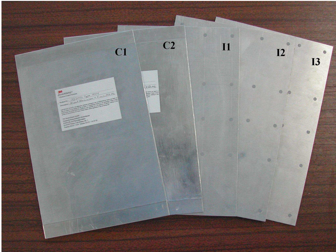
Figura 8.1: Provetes com tratamento mono-camada utilizados no estudo de validação
