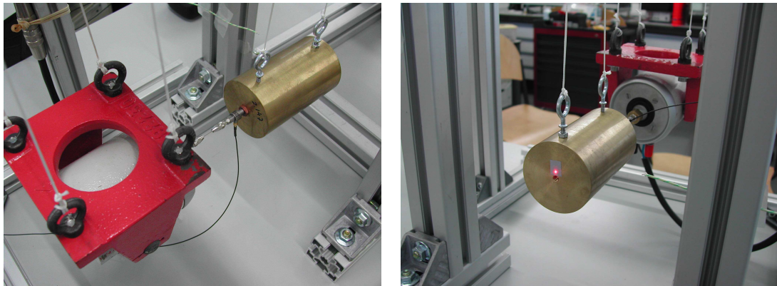
Figura H.9: Montagem experimental para calibração do par vibrómetro laser e BK8203-118
