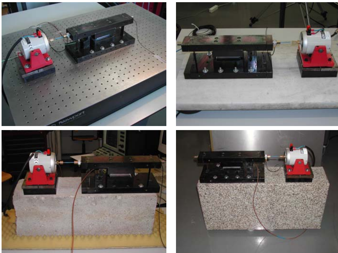
Figura 7.15: Suportes de apoio da montagem experimental: mesa de montagens, placa de mármore, bloco de betão e bloco de granito
