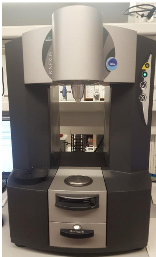
Figura 9 – Reômetro rotacional Malvern Kinexus lab +.
