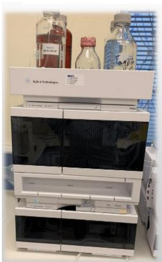
Figura 15 – Cromatógrafo Agilent 1260 series HPLC-PAD System.
