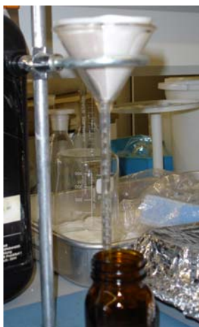
Figura 39: Filtração da amostra.
