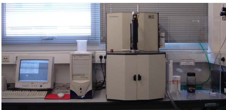
Figura 37: Pore Master - Porosímetro de Mercúrio.
