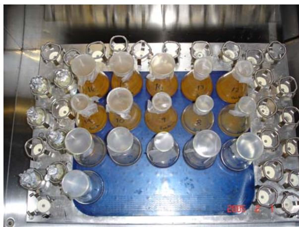
Figura 40: Amostras do ensaio de adsorção na incubadora orbital.
