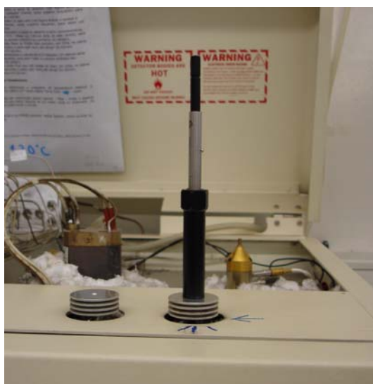
Figura 50: Fibra de SPME no injetor do GC.
