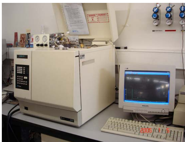
Figura 48: Cromatografia gasosa com detector de captura de electrões.
