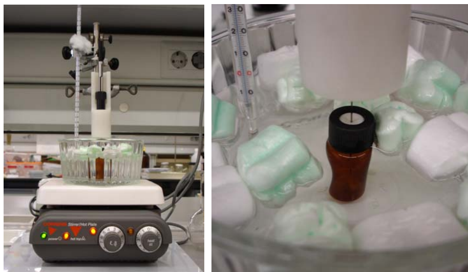
Figura 47: Placa de aquecimento com suporte para a fibra de SPME.
