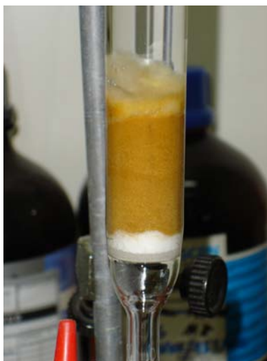
Figura 43: Coluna de adsorção com a casca de amêndoa.
