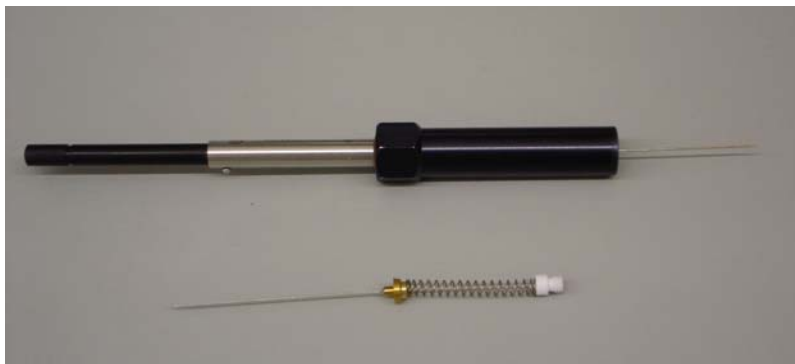
Figura 46: Suporte manual para fibras e fibra de SPME.
