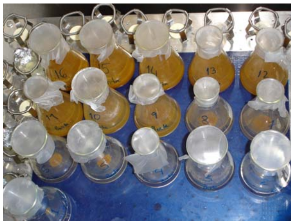
Figura 41: Amostras do ensaio de dessorção na incubadora orbital.
