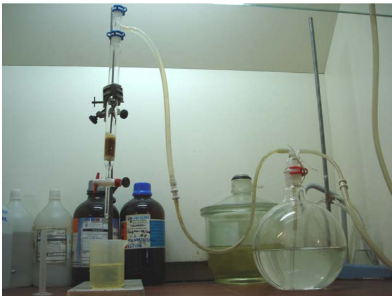
Figura 42: Instalação experimental dos ensaios em contínuo.
