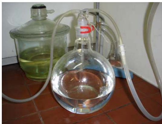
Figura 44: Balão de alimentação à coluna.
