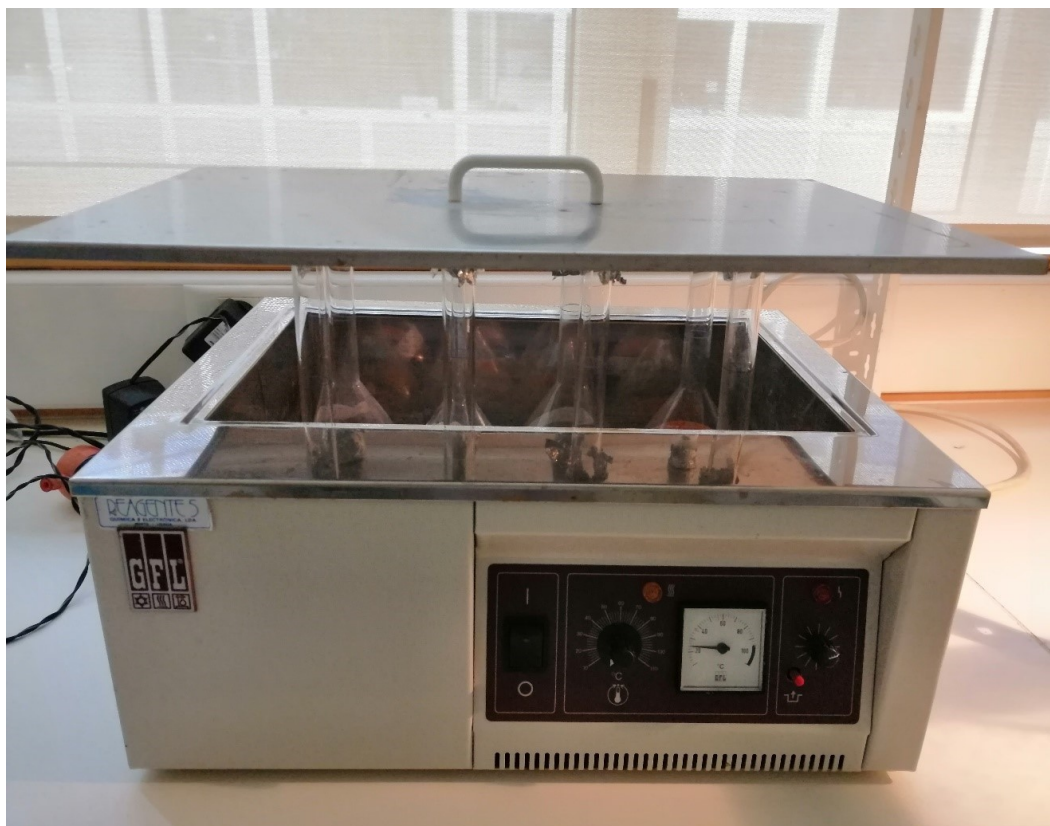
Figura 4. - Banho maria durante degradação da matéria orgânica das amostras de microplásticos.
