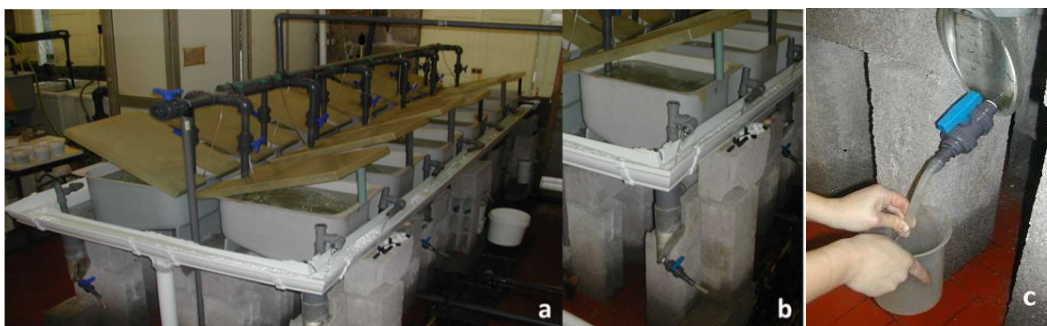
Fig. 6 – Sistema ensaio digestibilidade: a. perspectiva geral dos 12 tanques; b. coluna de sedimentação; c. recolha de fezes
