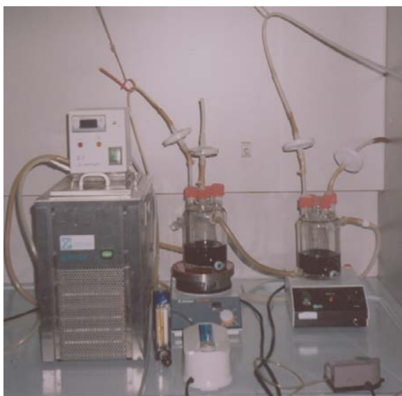
Figura 9. Instalação dos reactores batch para biodegradação dos polifenóis da água de cozedura de cortiça.
