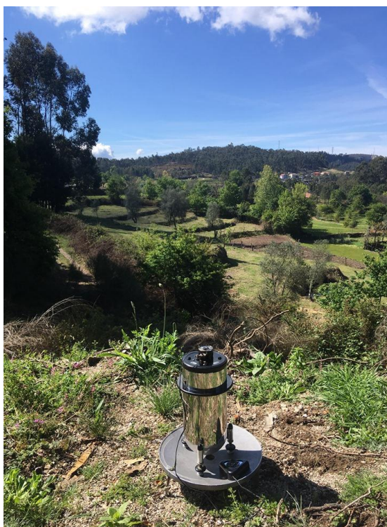
Figura 13: Gravímetro Worden Pioneer nº679
