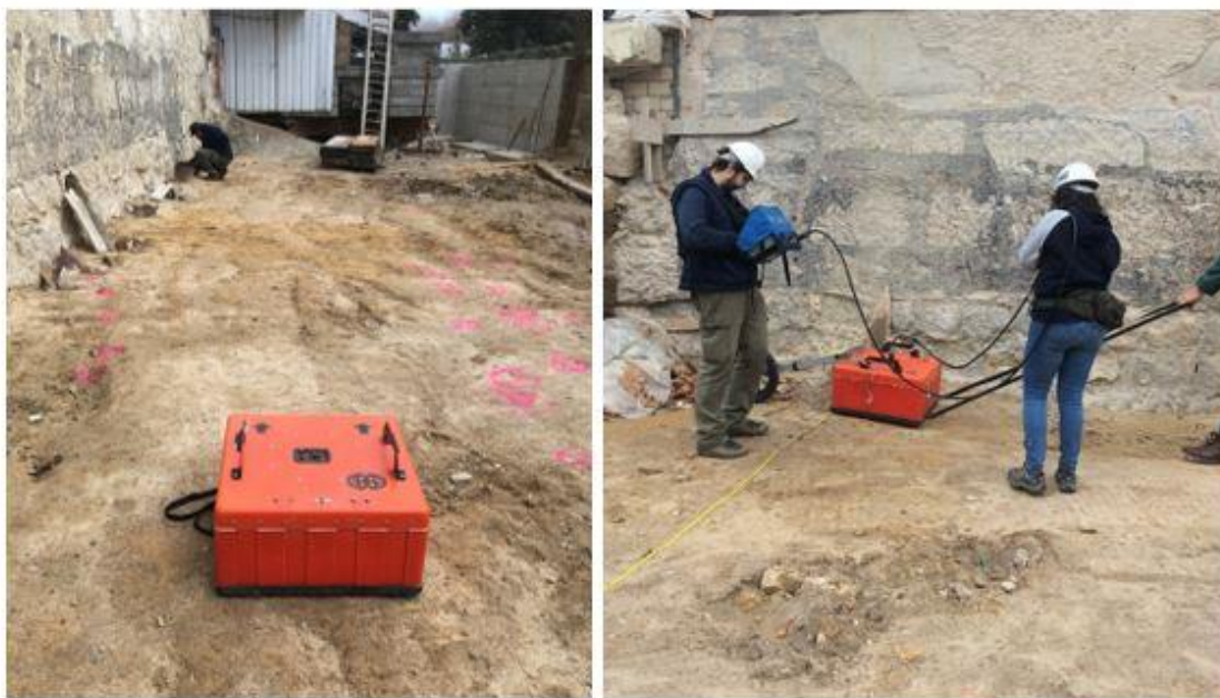
Figura 2: Utilização do GPR com uma antena de 200MHz
