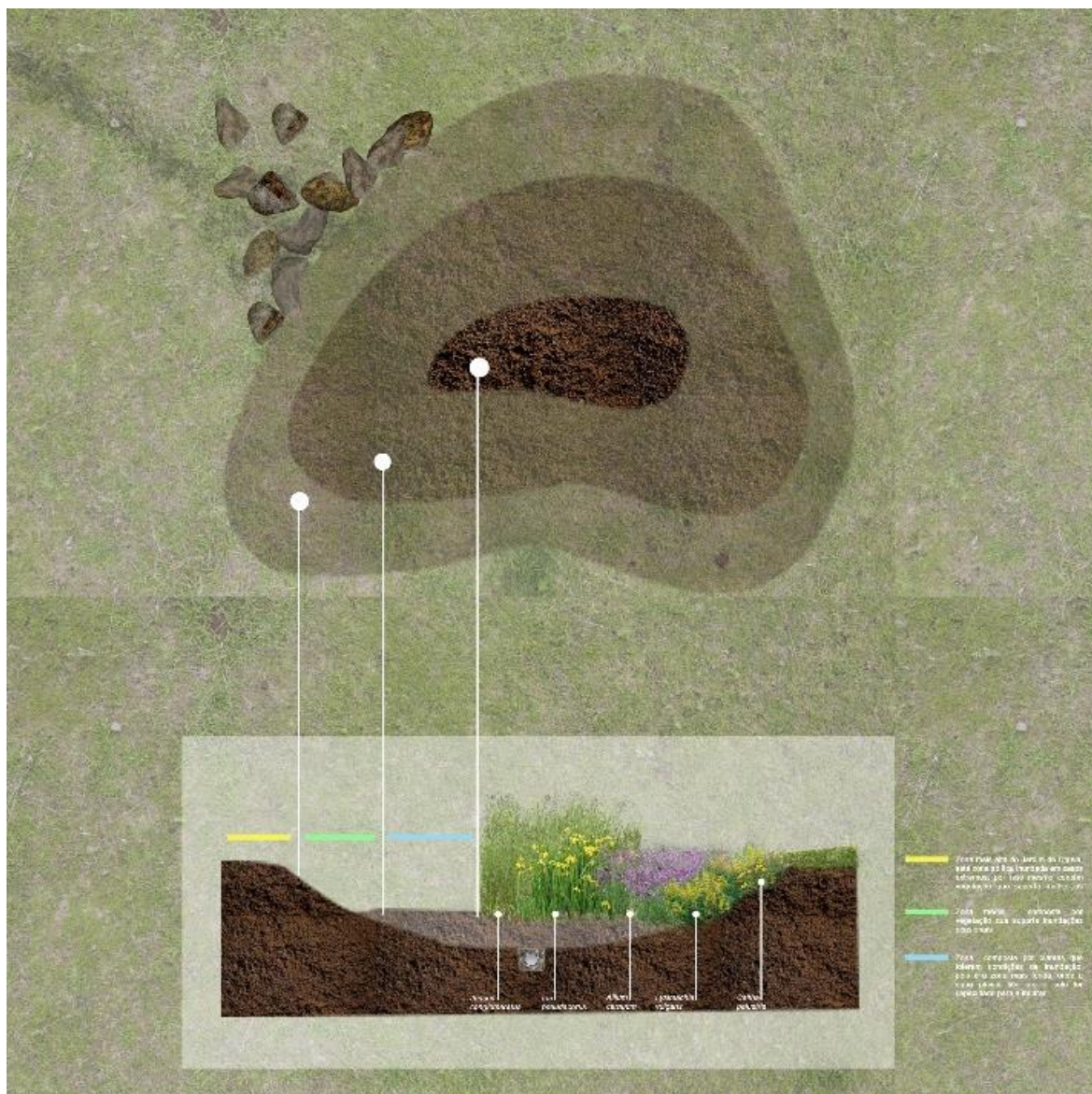
Figura 3 Exemplo das três zonas que constituem um jardim de chuva: zona seca, intermédia e de inundação Fonte: autora
