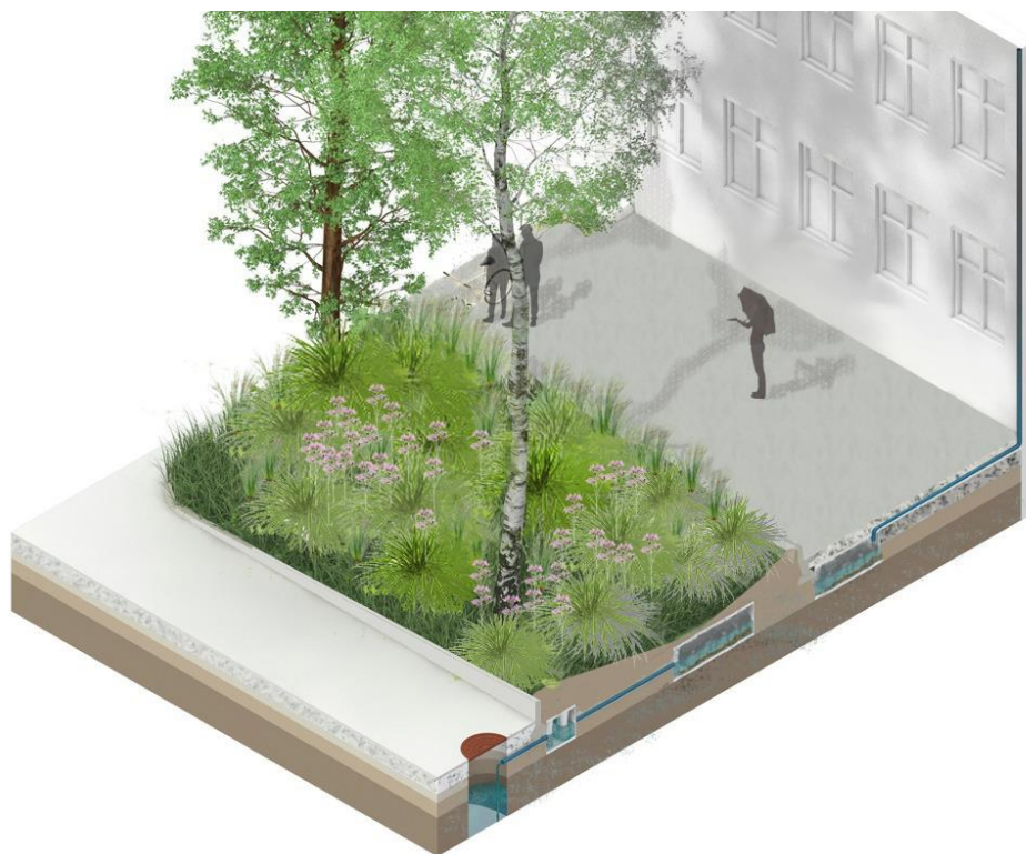
Figura 26 - Representação da vegetação e sistema de infiltração na Rua Diogo do Couto.
