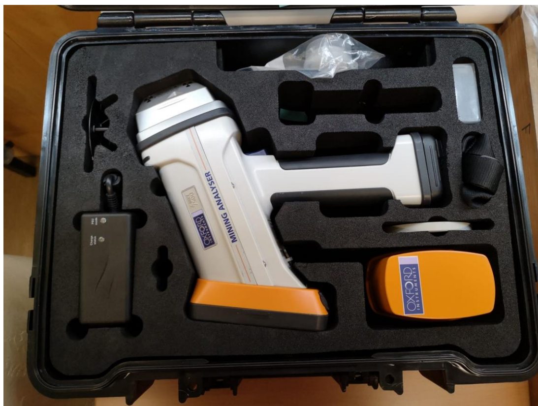
Figura 7 Equipamento para medição da composição química elementar Oxford Instruments série X-MET7000
