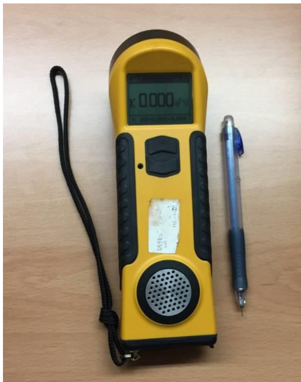
Figura 9 Equipamento para medição de suscetibilidade magnética KT-10 Magnetic Susceptibility Meter, da Terraplus
