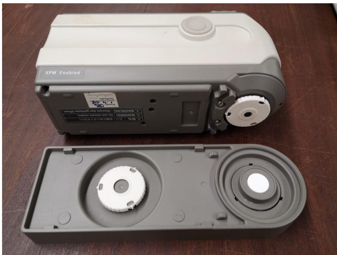
Figura 8 Equipamento para medição da cor, Konica Minolta CM-2600d (Espectrofotómetro)
