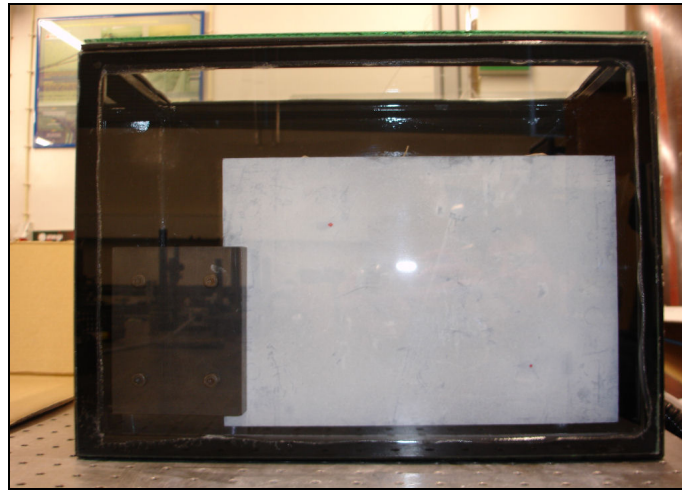
Fig. 5.33 – Imagem da montagem experimental da placa laminada compósita no interior da câmara hipobárica.
