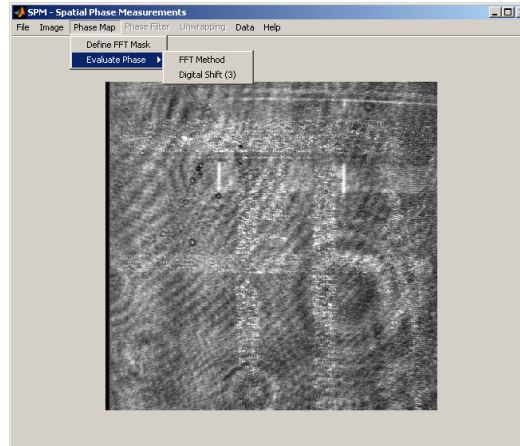
Fig. E.29 – Funções para o cálculo do mapa de fase pela técnica medição espacial de fase (SPM).
