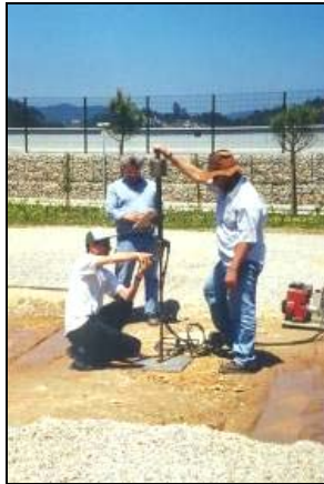
Figura 4.8 Ejecución del ensayo PDL
