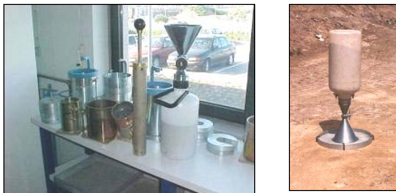
Figura 4.6 Calibración del cono de arena en laboratorio y cono de arena en obra
