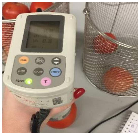
Figura 11: Leitura da cor da epiderme do fruto com o colorímetro Konica Minolta CR 400. (Fonte: Próprio autor).
