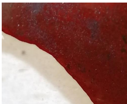
Figura 24 - Imagem exemplo uma membrana de quitosano e sílica com excesso de glutaraldeído (1,5:1 – Glut:CH)
