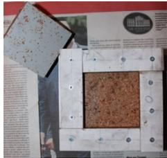
*Figura. 3.113—Molde 5 com mistura para teste 10.*
