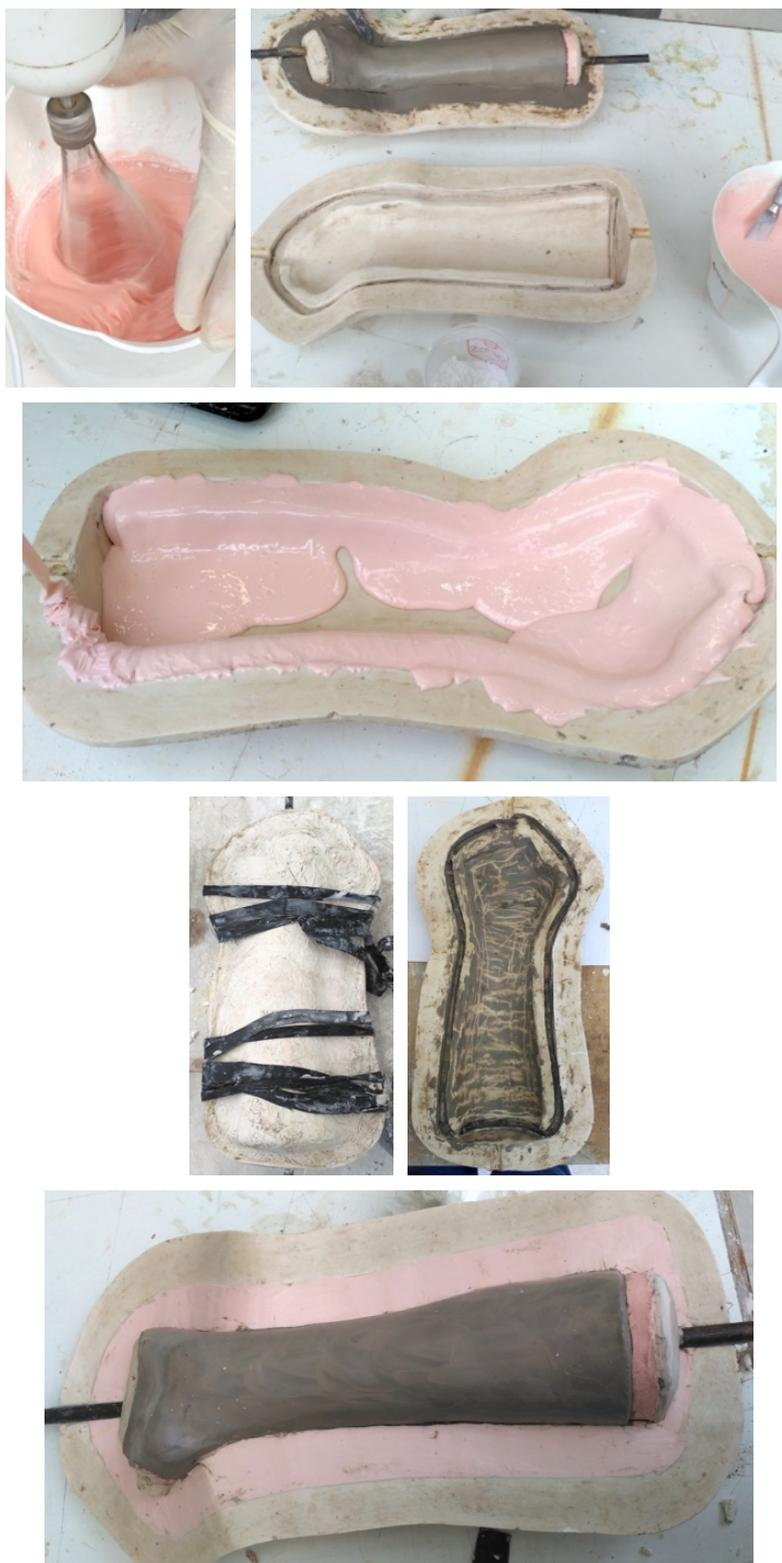
*Figura. 3.132—Fases do processo com aplicação de silicone na segunda etapa.*
