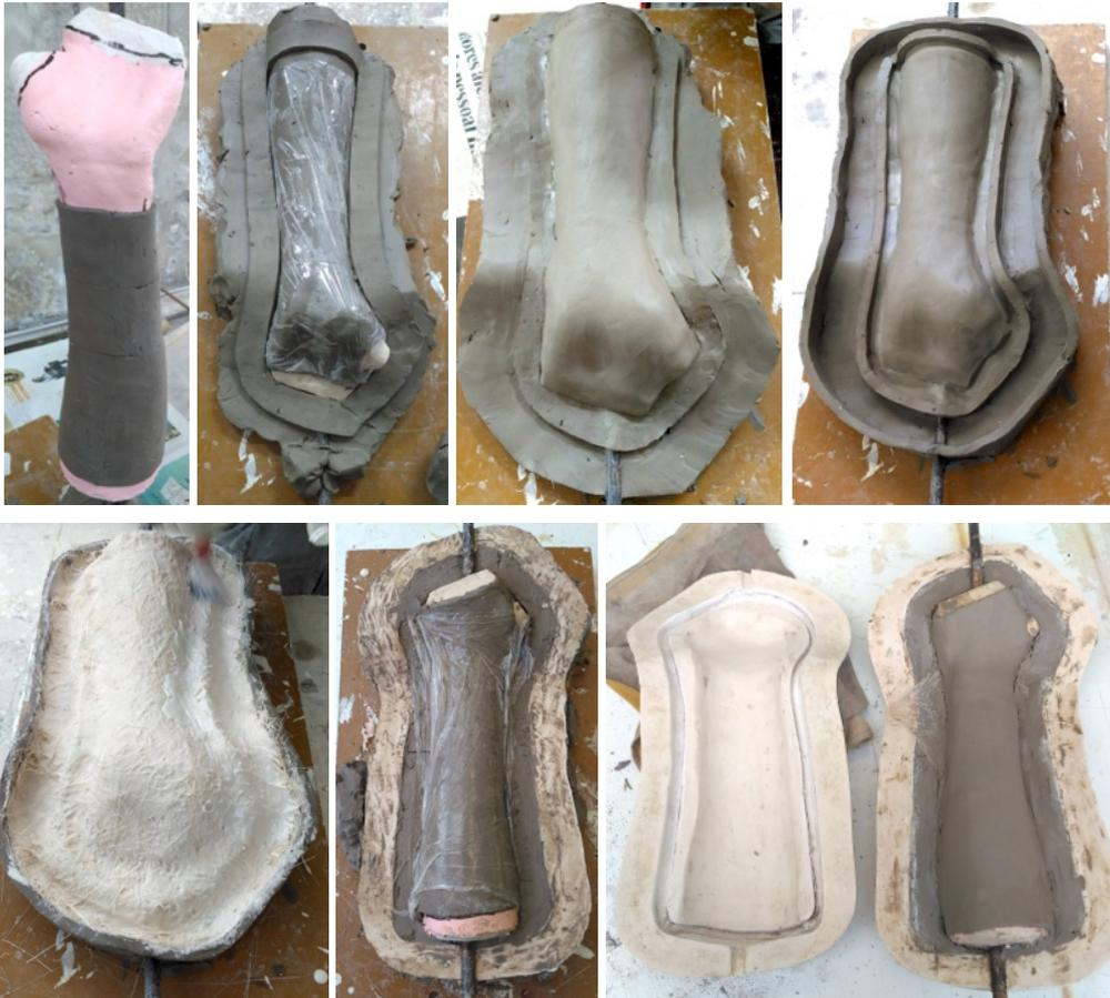
*Figura. 3.131—Demonstração da aplicação de barro e construção do molde em resina gesmonite.*
