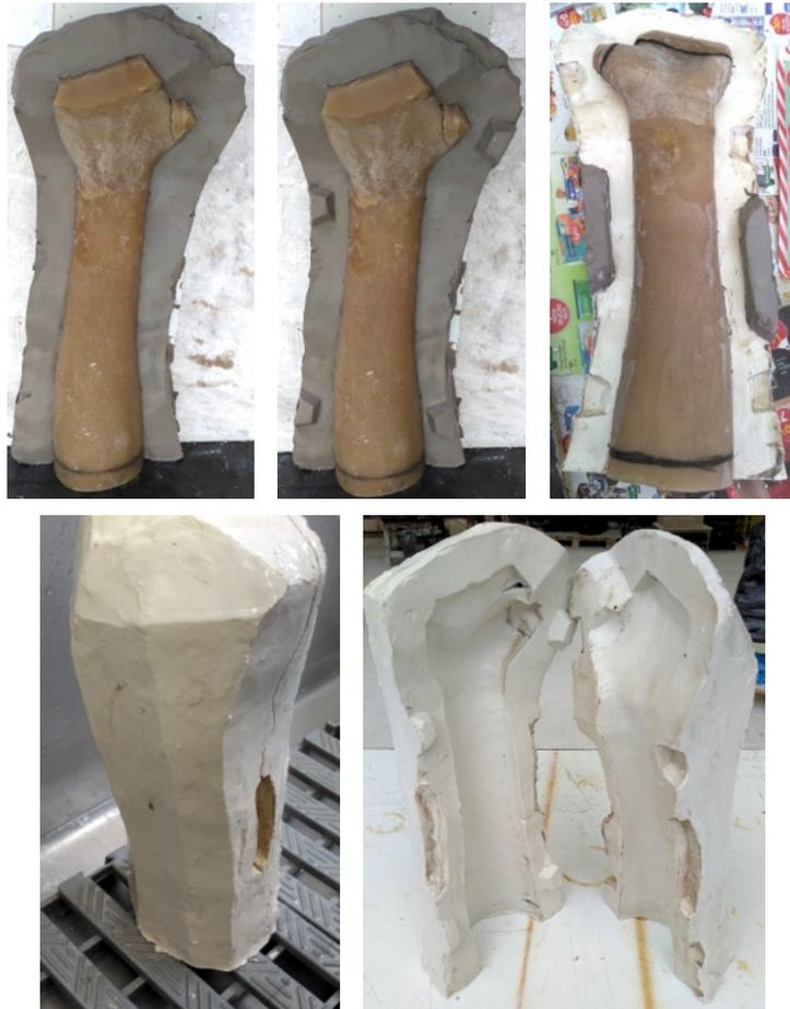
*Figura. 3.128—Primeiras etapas do processo de construção do molde 2.*
