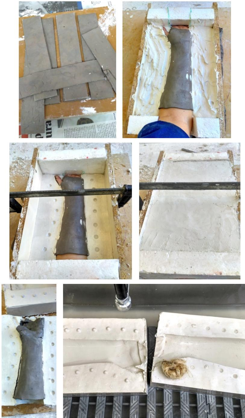
*Figura. 3.122—Processo de construção da primeira e segunda parte do Molde 1.*
