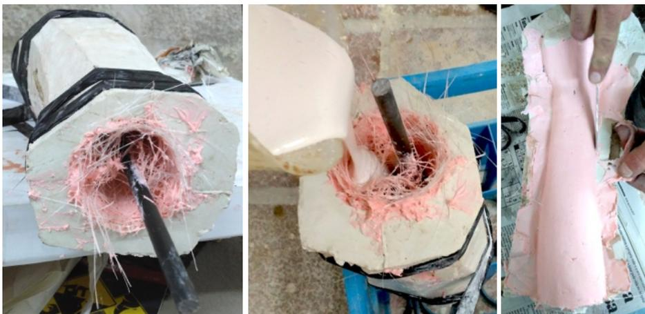
*Figura. 3.130—Derrame de resina gesmonite e limpeza de excessos.*
