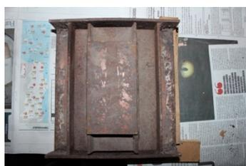
Figura. 3.101— Molde de ferro fechado com a mistura.
