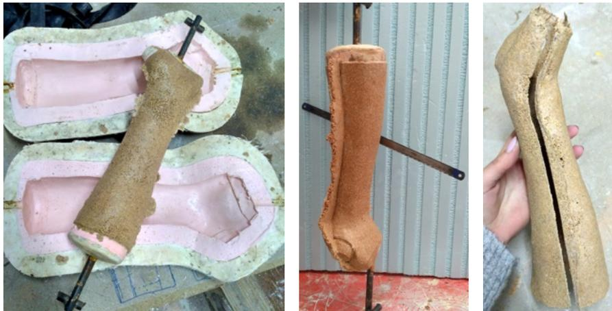
*Figura. 3.135—Processo de retirada do protótipo do molde.*
