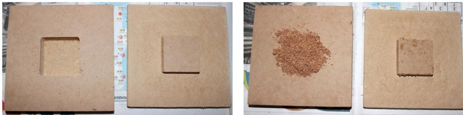
Figura. 3.91—Molde CNC antes e depois do depósito da mistura.
