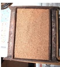
Figura. 3.100— Molde de ferro com mistura.
