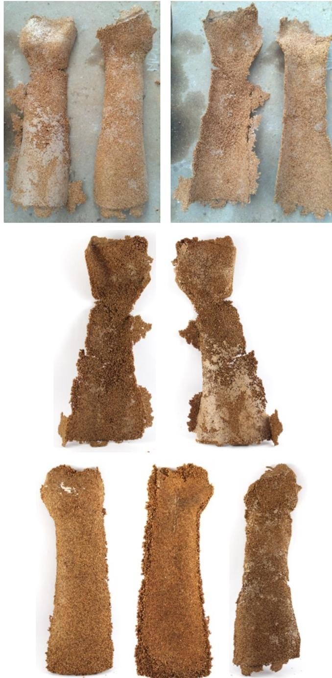
*Figura. B.1— Testes com elastómero de poliuretano e resina de poliuretano termoplástica.*
