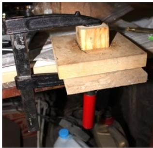
*Figura. 3.97—Pressão do molde efetuada com grampo.*
