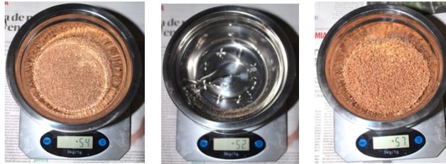
Figura. 3.90—Pesagem da cortiça, do adesivo de poliuretano e mistura efetuada, respetivamente.
