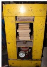
Figura. 3.92—Prensa hidráulica utilizada com compressão do molde.
