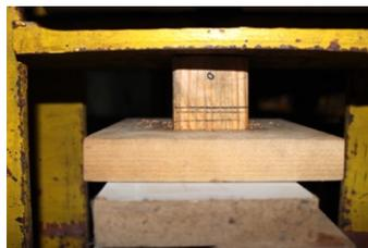
*Figura. 3.96—Molde a ser prensado.*
