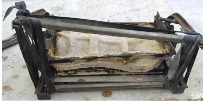
*Figura. 3.134—Molde 2 com estrutura de metal e pressão aplicada com elásticos.*
