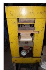
Figura. 3.102— Pressão aplicada no molde de ferro através de prensa hidráulica.
