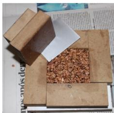
*Figura. 3.108—Molde com matéria-prima e chapa de metal*
