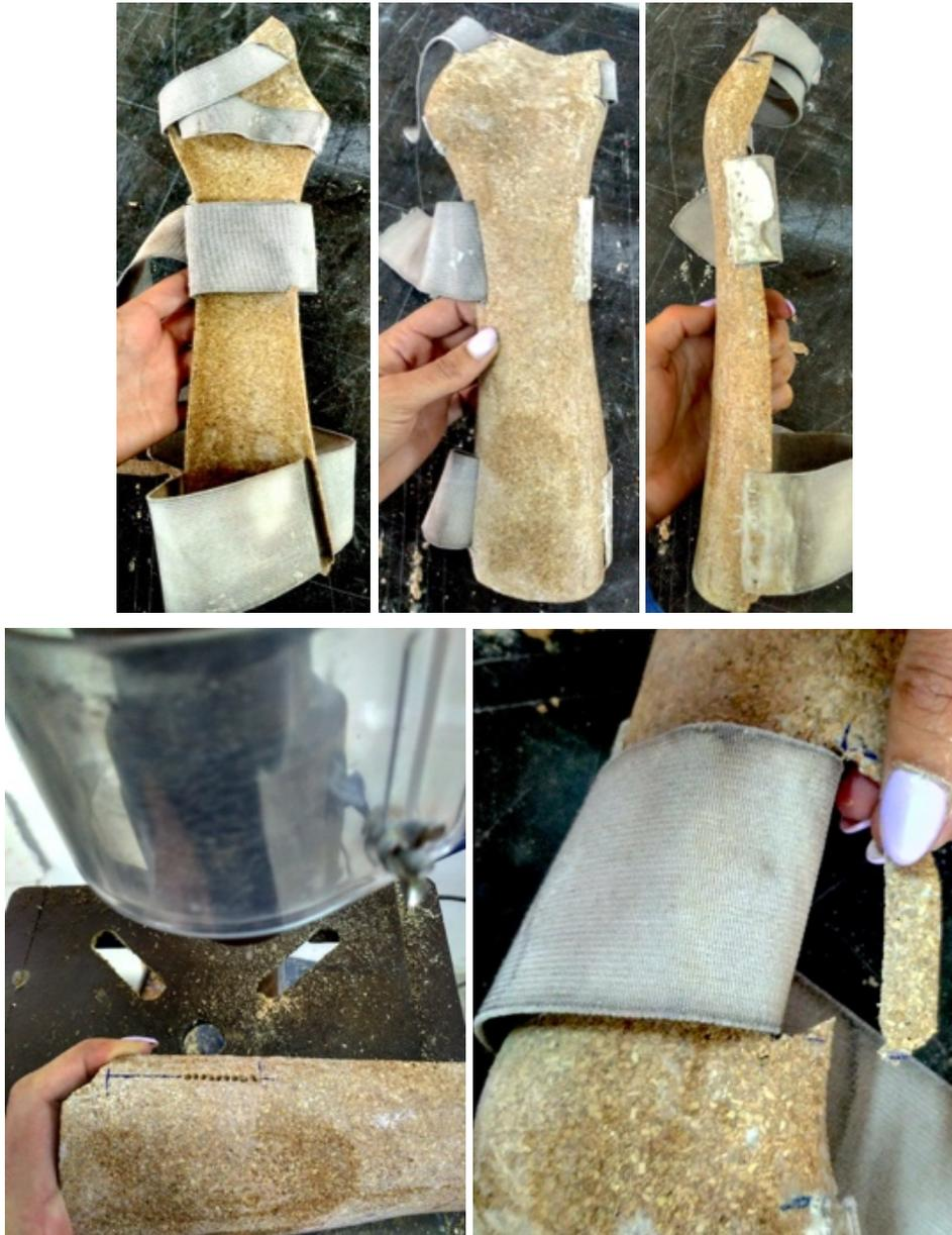
*Figura. 3.143—Protótipo 6 com elásticos e zona de fratura.*
