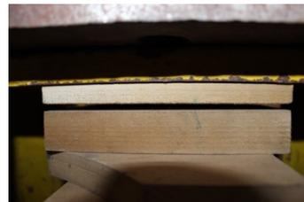
Figura. 3.93—Pormenor do molde após compressão com a mistura no seu interior.
