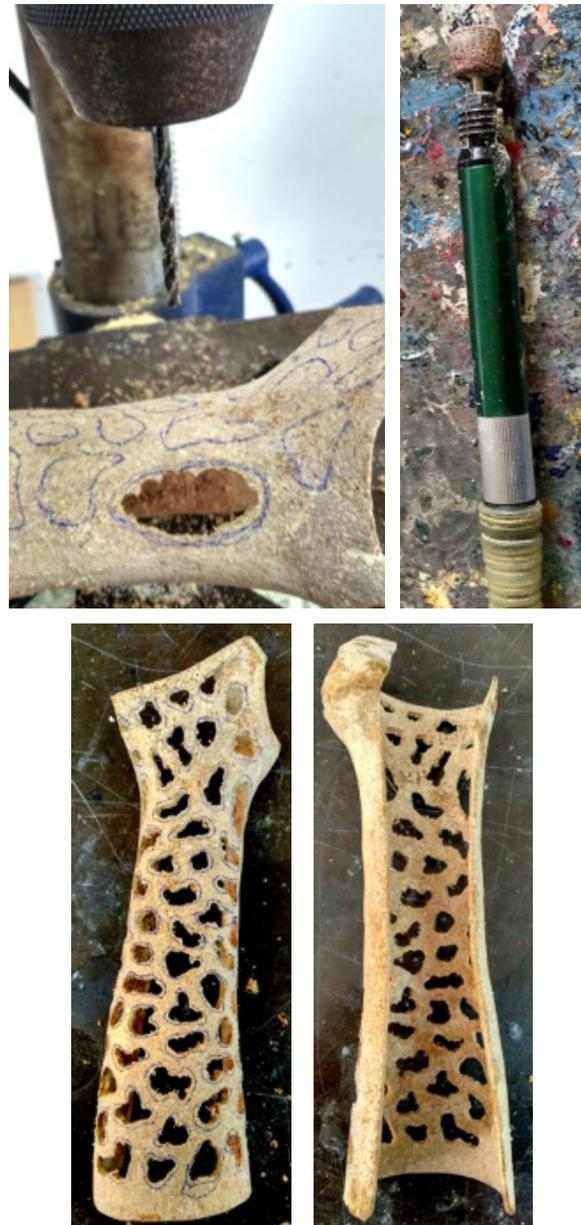
*Figura. 3.144—Protótipo 7, perfuração e lixa elétrica.*
