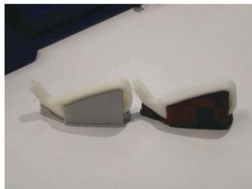
Figura 4.19 - Exemplo de peças obtidas pelo processo FDM, com dois tipos de suporte, sendo o da direita solúvel em água.
