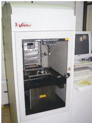
Figura 4.10 - Equipamento de estereolitografia (direita), mufla de pós-cura (esquerda), da 3D Systems.
