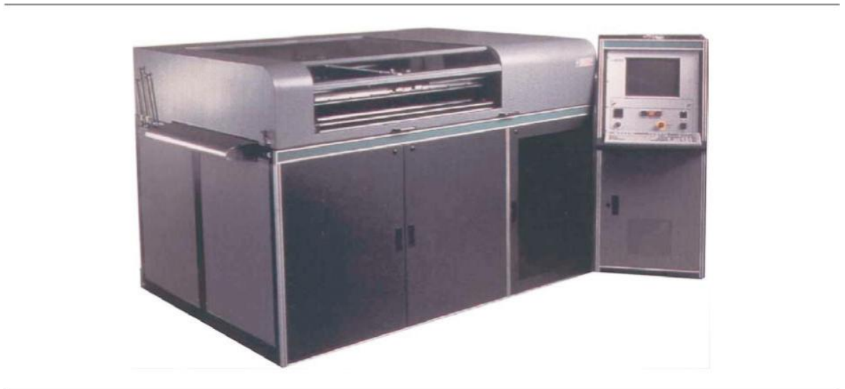
Figura 4.20 - Máquina de LOM da Helysis existente no INEGI.
