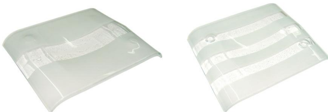
Figura 5.14 - Peças decoradas com o processo de grenalhagem (peça 1).
