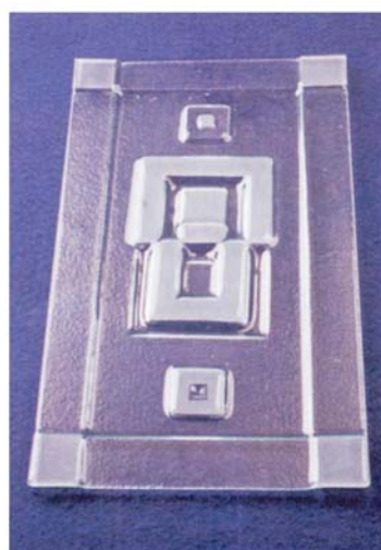
Figura 5.18 - Exemplo de uma peça obtida a partir de um molde de fibra cerâmica [3].
