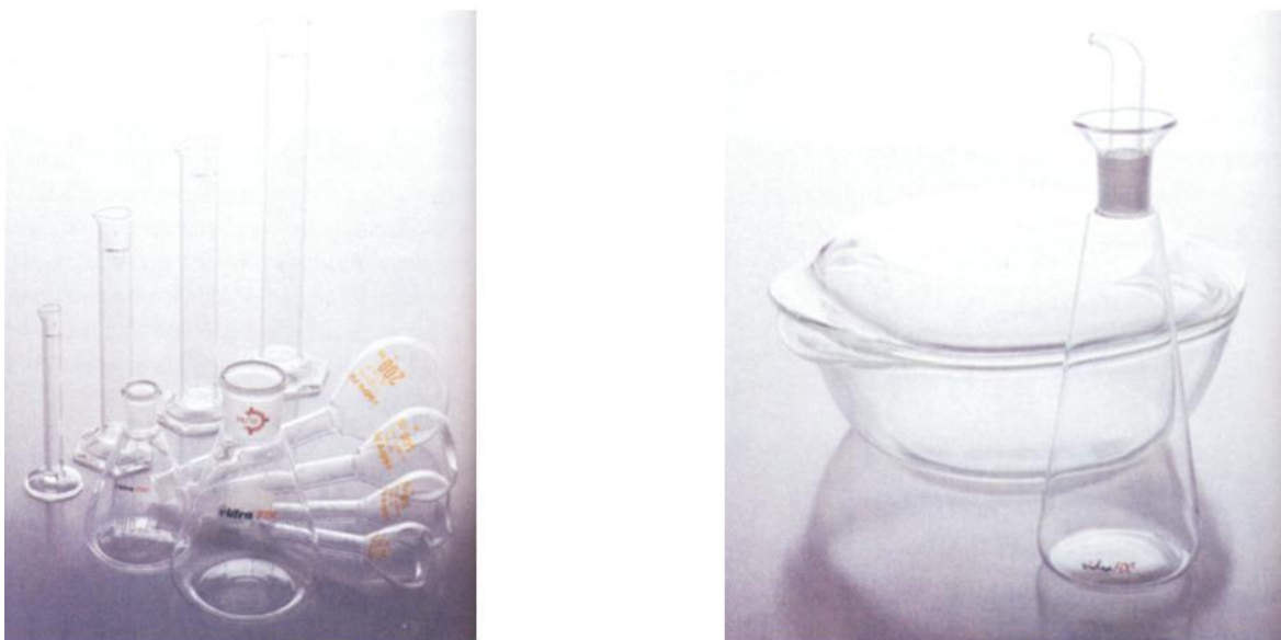
Figura 1.8 - Instrumentos de laboratório e de cozinha executados com vidro de boro-silicato [3].
