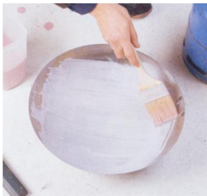
Figura 1.16 - Exemplo de molde em aço utilizado na termoformação [3].
