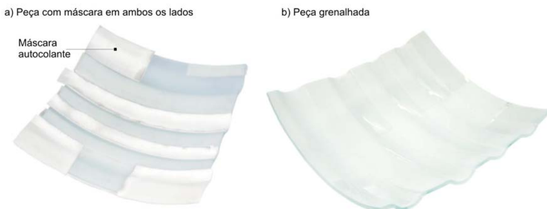
Figura 5.15 - Peças decoradas com o processo de grenalhagem (Peça 2).
