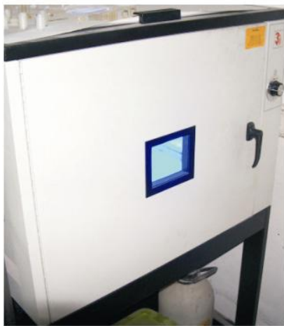
Figura 4.13 - Peça em SL em processo de pós-cura.
