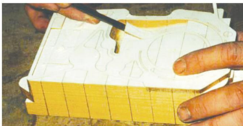
Figura 4.22 - Remoção do material excedente (descubagem) para retirar o modelo.
