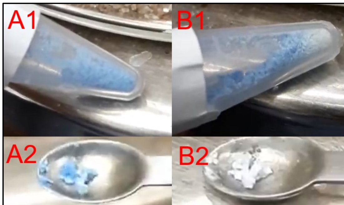
Figura 3.37 - Termocromismo do ensaio 25 antes (A) e após aquecimento a 70 °C (B).
