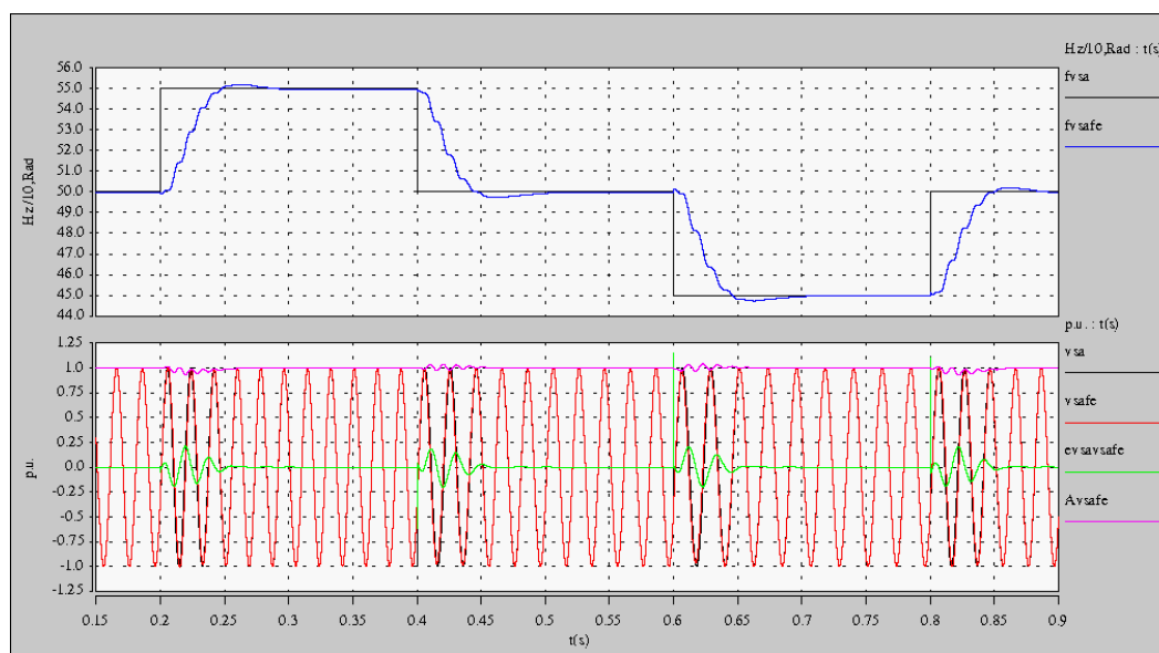
Figura 3-31 – Resposta do método EPLL a uma variação de frequência em degrau.
