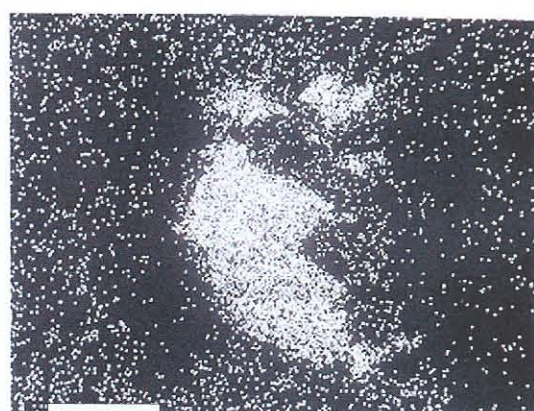
Foto 22 Imagem de Raios X, mostrando a distribuição do Ta na área da foto 19. Dimensão da barra branca: 50 µm.
