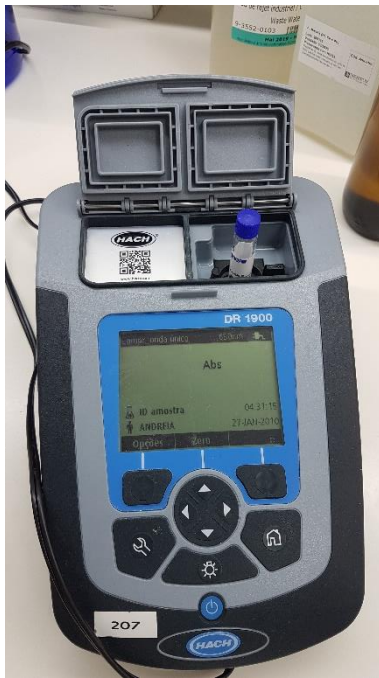
Figura 12: Cuvete de ensaio acoplado ao fotómetro para fazer a leitura.
