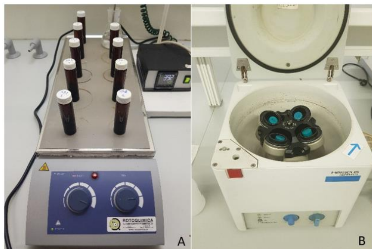
Figura 15. Extração das amostras. A - Placa magnética de agitação com temperatura controlada, B - Centrífuga Habraeus 4500rpm
