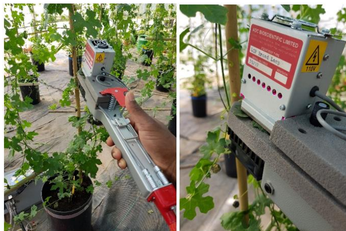
Figura 12. Leitura de dados fisiológicos em acessos de cacana com o aparelho IRGA LCPro – SD
