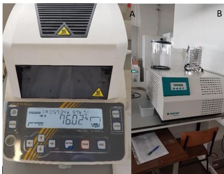
Figura 13. A- Balança para determinação de teor de humidade; B-Liofilizador Telstar Cynodos 80
