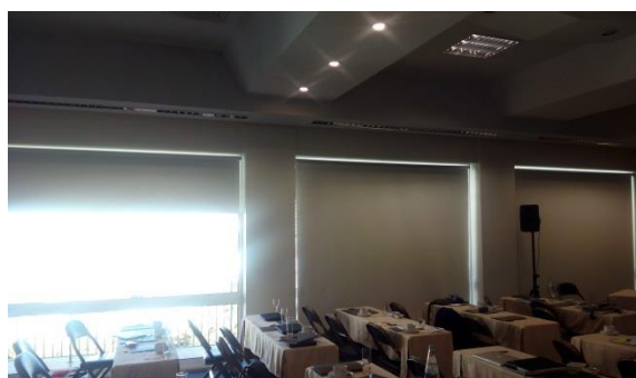
(d) Vãos simples com vidro duplo incolor. Proteção solar interior, do tipo estores de lona opaca de cor clara.
