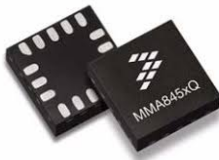
Figura 49 - Acelerómetro Freescale™ MMA8452
