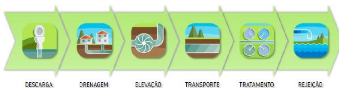
Fig. 2. 8 - Constituição típica de um SAR (ERSAR, 2019)
