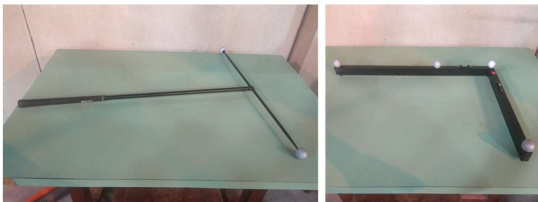
Fig. 71 – Instrumentos de calibração do sistema Qualisys .
