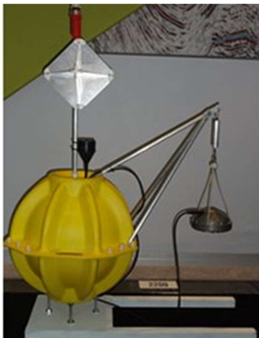
Fig. 7 – Configuração dum sismómetro de fundo do mar OBS32.
