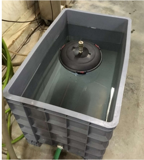
Fig. 75 – Modelo simplificado no pequeno tanque onde foram realizados os ensaios de extinção.
