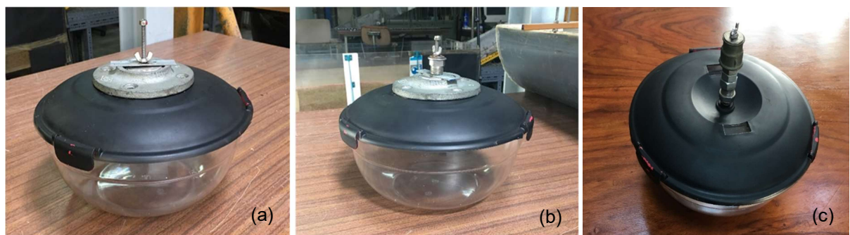
Fig. 85 – Fotografia das diferentes configurações do lastro do modelo simplificado: (a) configuração 1; (b) configuração 2; (c) configuração final.
