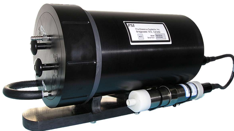
Fig. 1 – Configuração dum sensor CO 2 – Pro Sensor.
