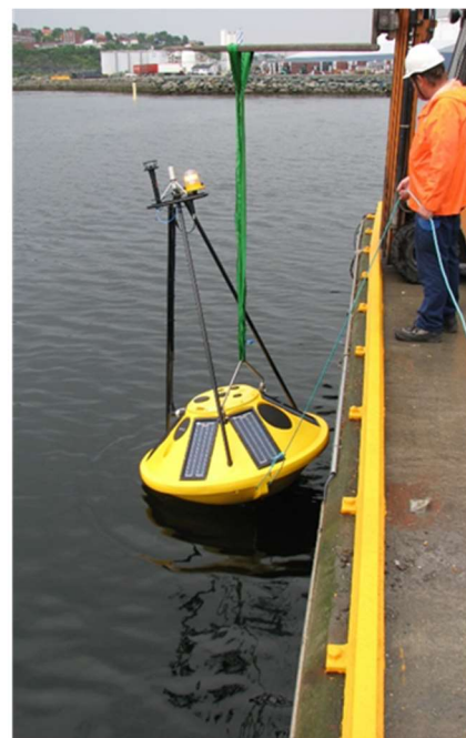
Fig. 14 – Configuração de uma bóia SEAWATCH Midi 185.
