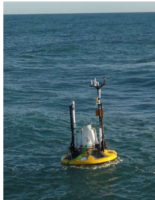
Fig. 15 – Configuração de uma bóia SEAWATCH Wind LiDAR.
