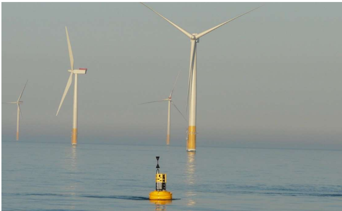
Fig. 5 – Bóia equipada com um perfilador de ventos próxima dum parque eólico ( Magazine , 2013).
