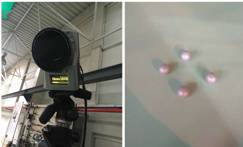
Fig. 69 – Câmera ProReflex MCU (esquerda), marcas reflectoras (direita).
