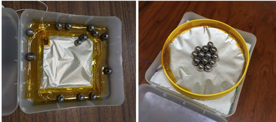
Fig. 92 – Design inicial do TENG (esquerda) e design final do TENG após as alterações mencionadas (direita).
