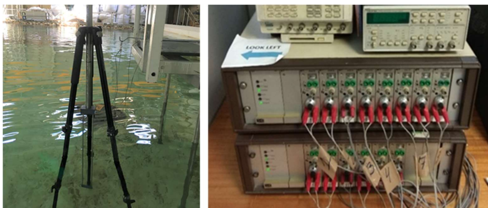
Fig. 68 – Sonda de níveis hidrodinâmicos de haste longa (esquerda), unidade de condicionamento do sinal (direita).
