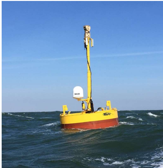
Fig. 20 – Bóia amarrada de vigilância equipada com cameras 360° e um radar.
