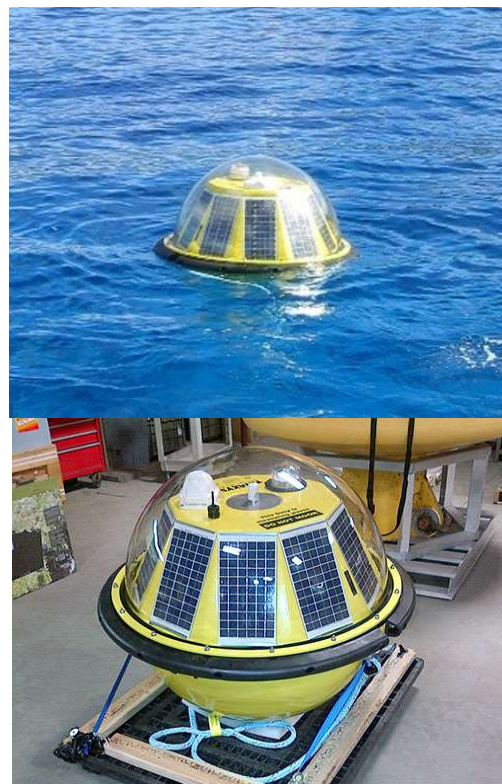
Fig. 11 – Configuração de uma bóia ondógrafo Triaxys
