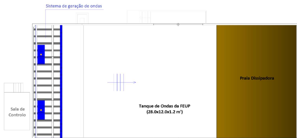
Fig. 65 – Esquema do tanque de ondas do laboratório de hidráulica da FEUP (SHRHA, 2018).
