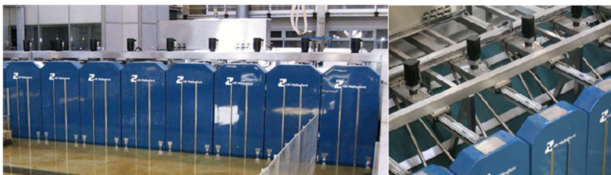
Fig. 66 – Sistema de geração agitação marítima do Laboratório de Hidráulica da FEUP (Taveira-Pinto et al. , 2007).
