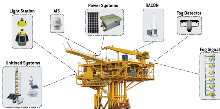
Fig. 35 – Esquema dos sistemas anexos a uma plataforma petrolífera (Tideland, 2017).
