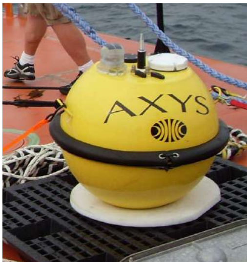
Fig. 12 – Configuração de uma boia ondógrafo Triaxys Mini
