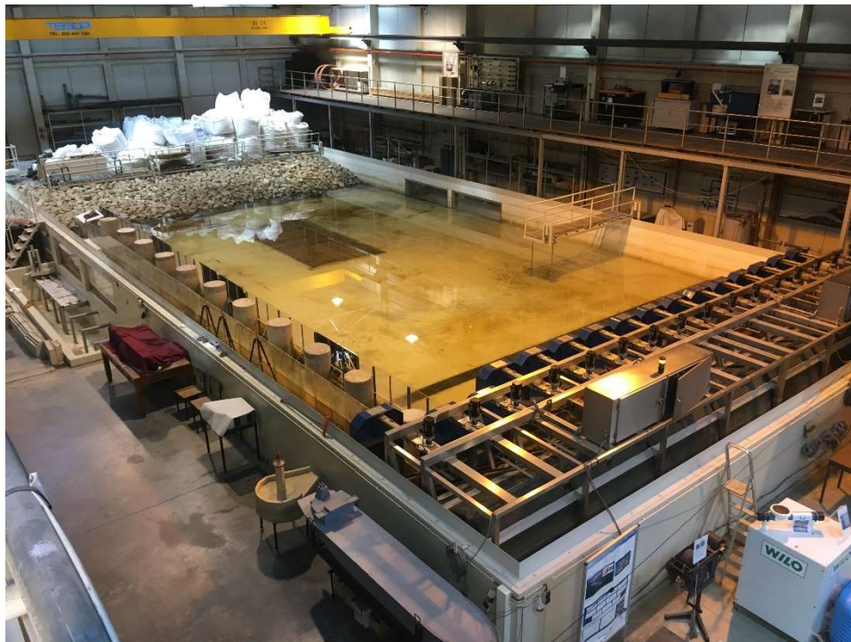
Fig. 64 – Fotografia do tanque de ondas do laboratório de hidráulica da FEUP.
