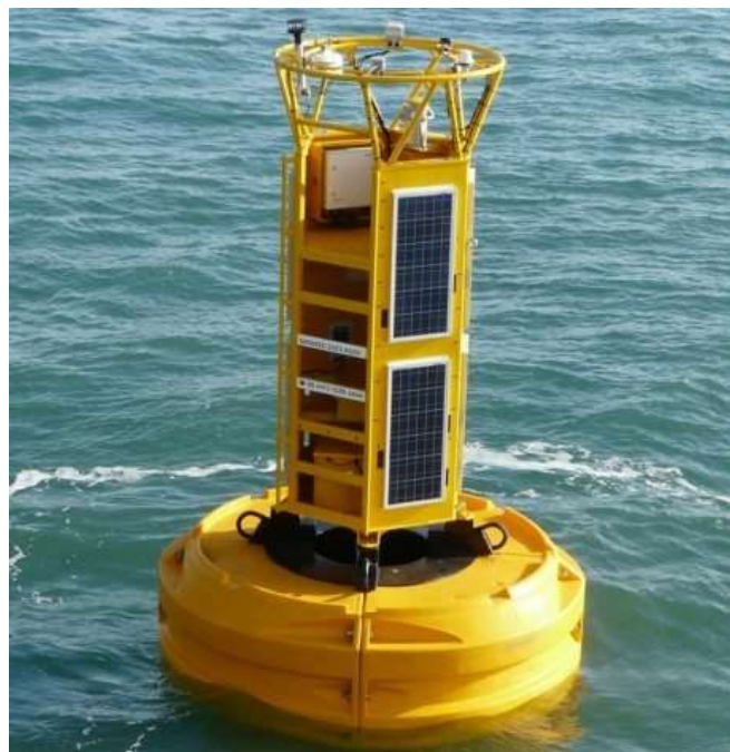
Fig. 21 – Configuração de uma bóia MOBILIS DB 8000
