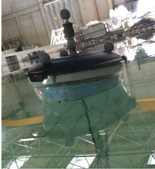
Fig. 90 – Fotografia da inclinação apresentada pelo modelo simplificado para a configuração inicial do TENG.
