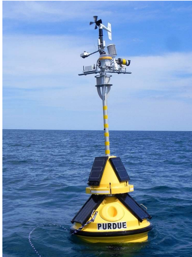
Fig. 18 – Bóia de monitorização equipada com um anemómetro de hélice (Phys, 2019).
