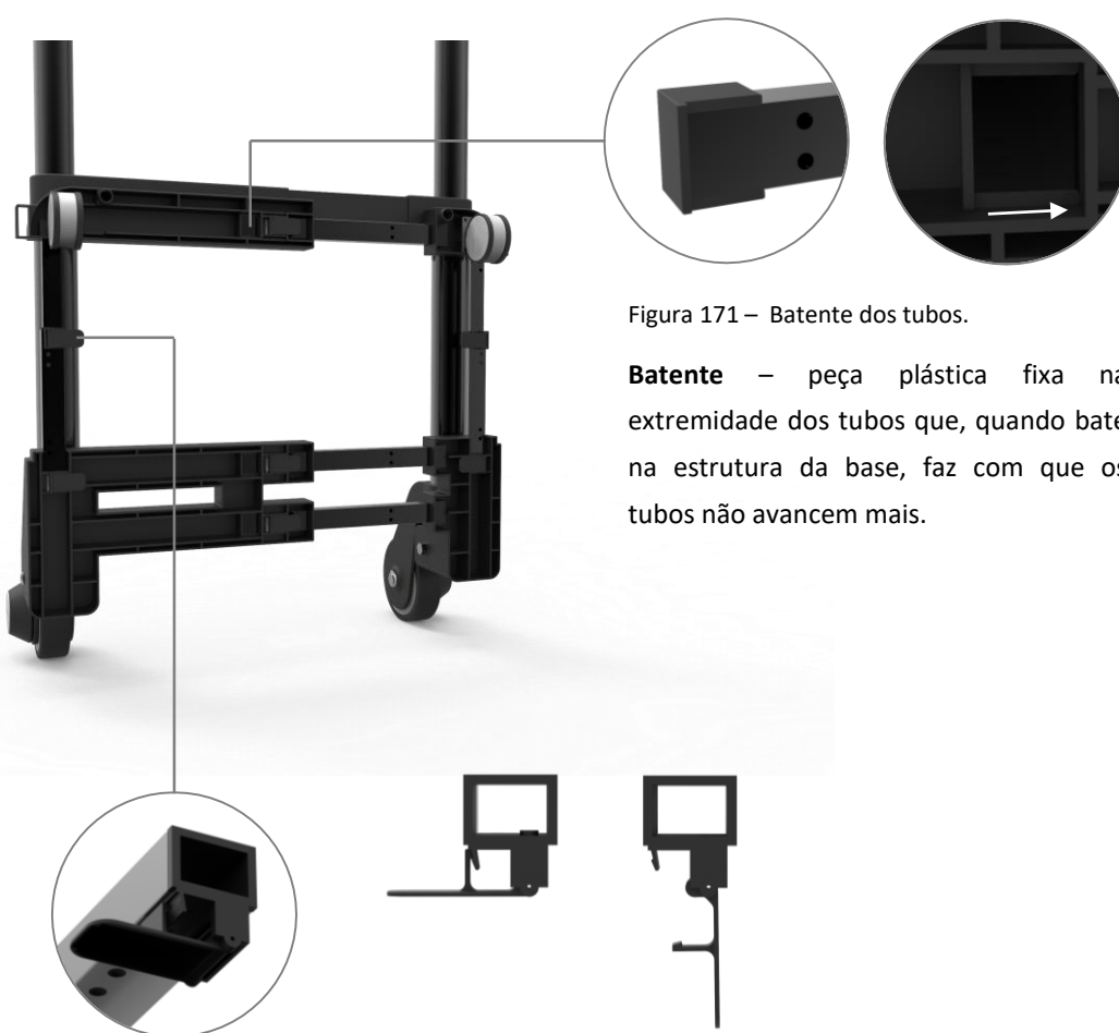
Figura 172 – Patilha de fixação dos tubos.
