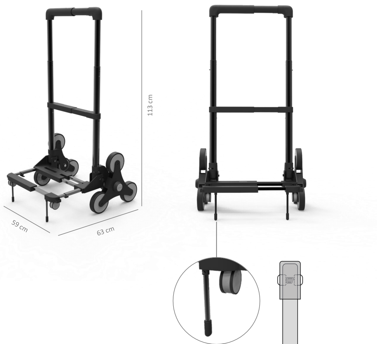
Figura 189 – Apoios de alumínio das rodas triplas.
