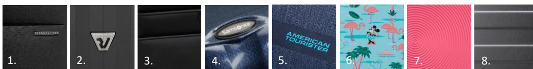
Figura 09 – Materiais mais aplicados nas malas de viagem 1. Poliéster (Pacomartinez 2019a); 2. Policarbonato (Roncato 2019c); 3. Nylon (Roncato 2019b); 4. Curv (Samsonite 2019e); 5. Nylon com poliéster (Tourister 2019b); 6. ABS (Tourister 2019a); 7. Polipropileno (Tourister 2019c); 8. Policarbonato com ABS (Pacomartinez 2019b).
