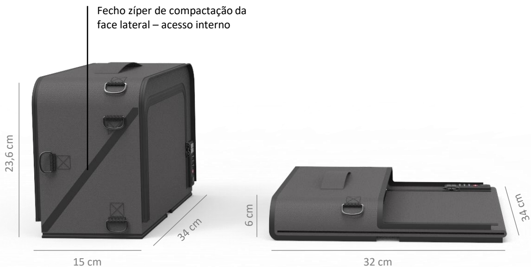
Figura 149 – Forma normal e forma compacta do módulo base.
