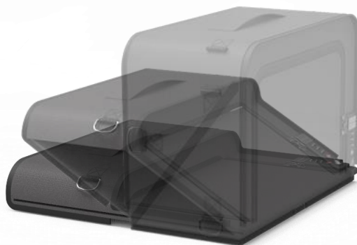
Figura 150 – Movimento de compactação.
