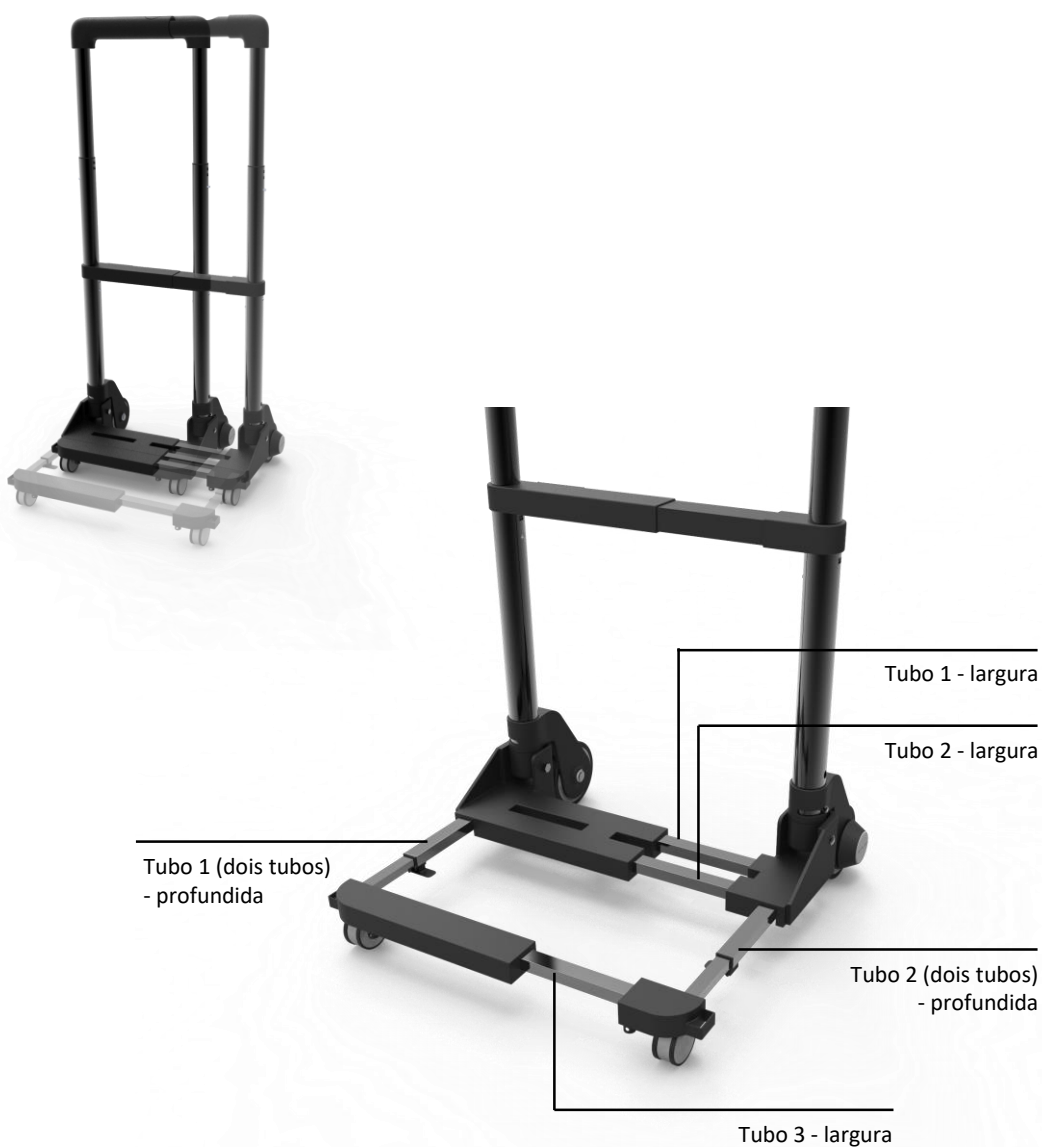
Figura 170 – Sistema de extensão da base.
