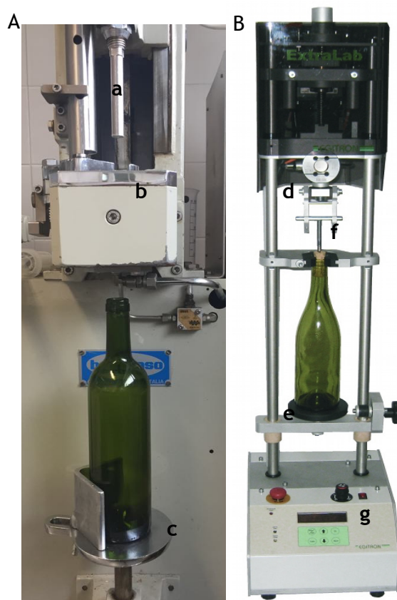
Figura 3.5 - Equipamentos utilizados nos ensaios de forças de extração: Rolhadora Epsilon R/S, da Bertolaso (A) e Extralab da Egitron (B). Legenda: a - pistão; b - câmara da maxila; c - suporte; d - cabeça de extração; e - suporte; f - saca-rolhas, g - comandos de controle.
