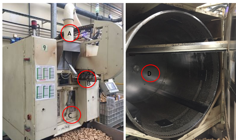
Figura 2.15 - Equipamento utilizado no TS de rolhas de cortiça: A- entrada das rolhas; B - injeção do produto; C - saída das rolhas; D - tambor rotativo.
