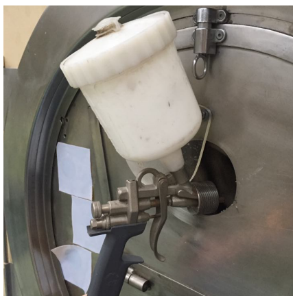
Figura 3.4 - Pulverizador de água. Legenda: a - depósito de água.
