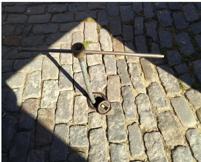
Figura 38 - Chave de manobras usada para cortar e reabrir o AA na presa ou tomada.
