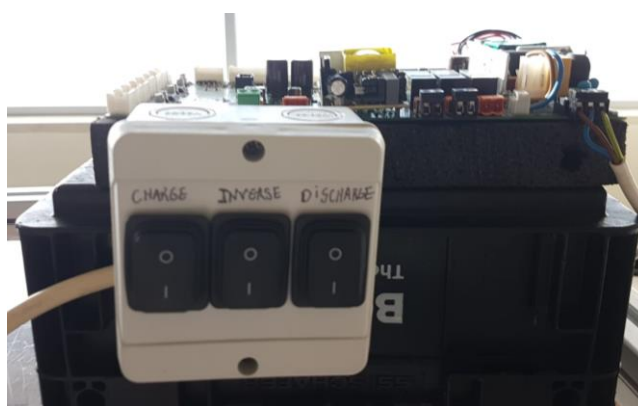
Figura A.4.3. Unidade de controlo eletrónico manual com interruptores de carga, inversão de polaridade e descarga (neutro).
