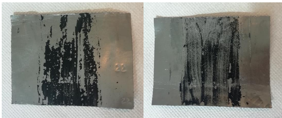
Figura A.1.12. Eléttodos NTC-HNO 3 +PVDF+DMF (20 mL) + Triton (900 µL) -aplicação com pincel.
