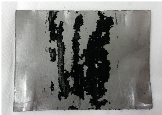
Figura A.1.9. Elétrodo NTC-N+PVDF+DMF (25 mL) - aplicação com pincel.
