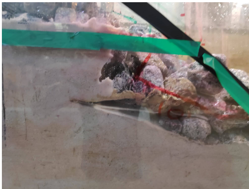
Figura 62- Infraescavação por efeito de parede no ensaio B2.1
