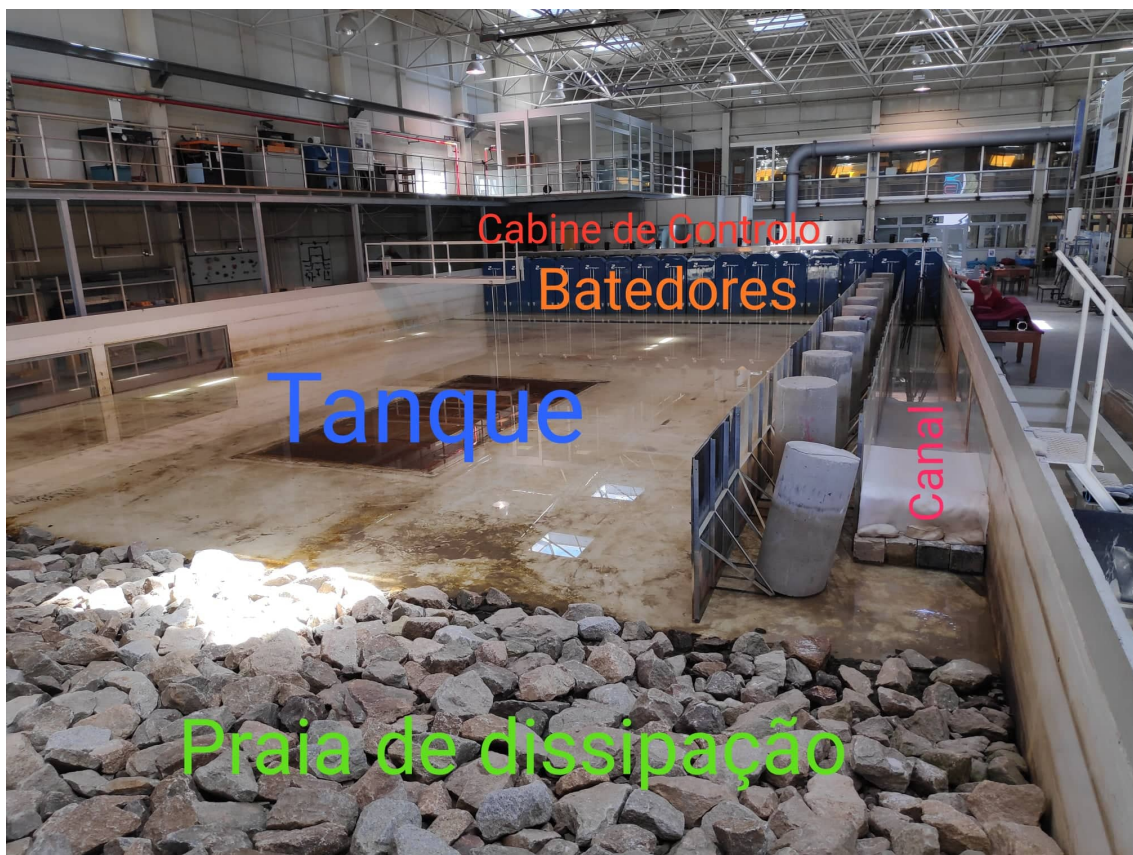
Figura 46- Tanque de Ondas da FEUP
