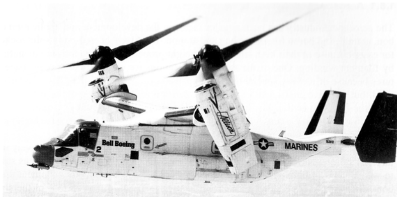
Figura 20 – V-22 Osprey, utilizando compósitos em cerca de 50% da sua estrutura.
