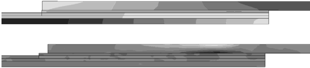
Figura 221 – Rotura adesiva de uma junta em sobreposição dupla.
