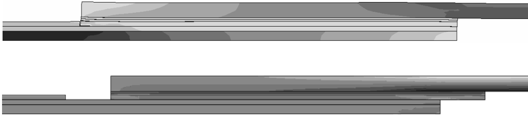
Figura 223 – Rotura intralaminar de uma junta em sobreposição dupla.
