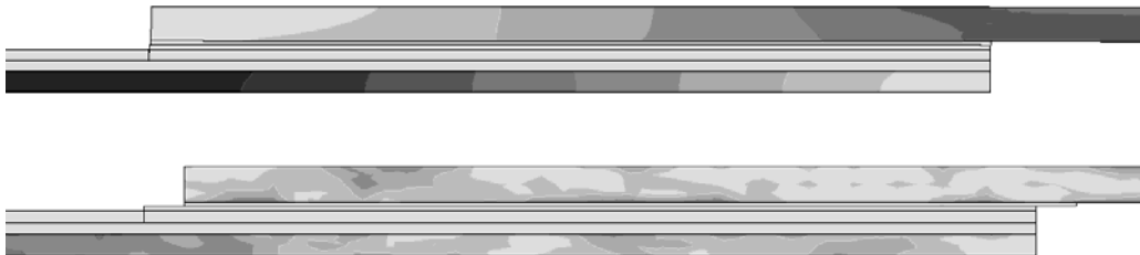
Figura 222 – Rotura coesiva de uma junta em sobreposição dupla.
