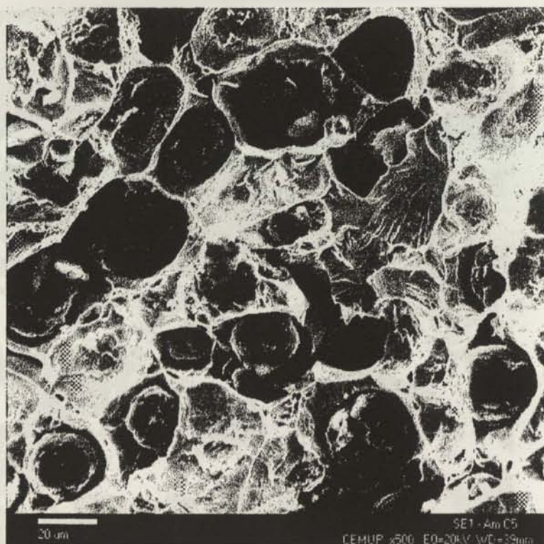
Figura 148 – Observação por SEM da superfície de fractura de um provete de FNA ( R_m=503,9\text{MPa} e A=13,9\% ), mostrando a presença de cadeias de nódulos alinhados na matriz: a) (x150) b) (x500).
