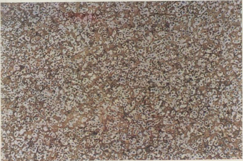
Figura 73 – Microestrutura do FNC ligado com 0,5Mn e 1%Cu. Ataque Nital 4% (x100).
