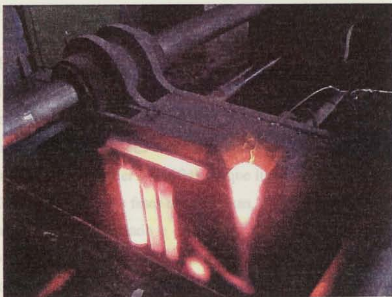
Figura 58 – Cacho a aguardar o fim da solidificação do metal na cabeça de vazamento para desmoldação e transporte imediato até ao banho de sais.
