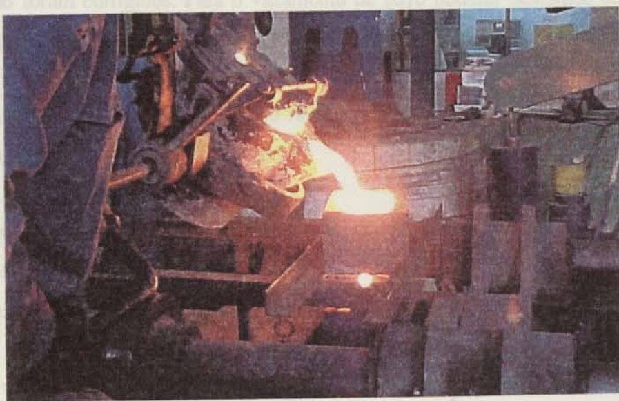
Figura 49 - Enchimento da coquilha através de uma bacia fabricada em areia de resina, destinada à inoculação in-mold com blocos electrofundidos.
