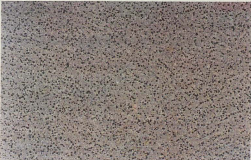
Figura 93 – Matriz do FNC arrefecido a uma velocidade de 12°C/min, após austenitização a 900°C. Ataque Nital 4% (x100).
