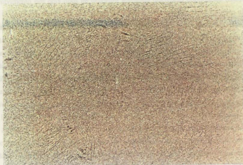
Figura 163 – Microestrutura típica das amostras de FNC observada nos cortes longitudinais dos tarugos: a) Periferia (x8) b) Centro (x8). As áreas escuras da observação á lupa (x8) identificam as zonas da matriz de baixa densidade de nódulos.
