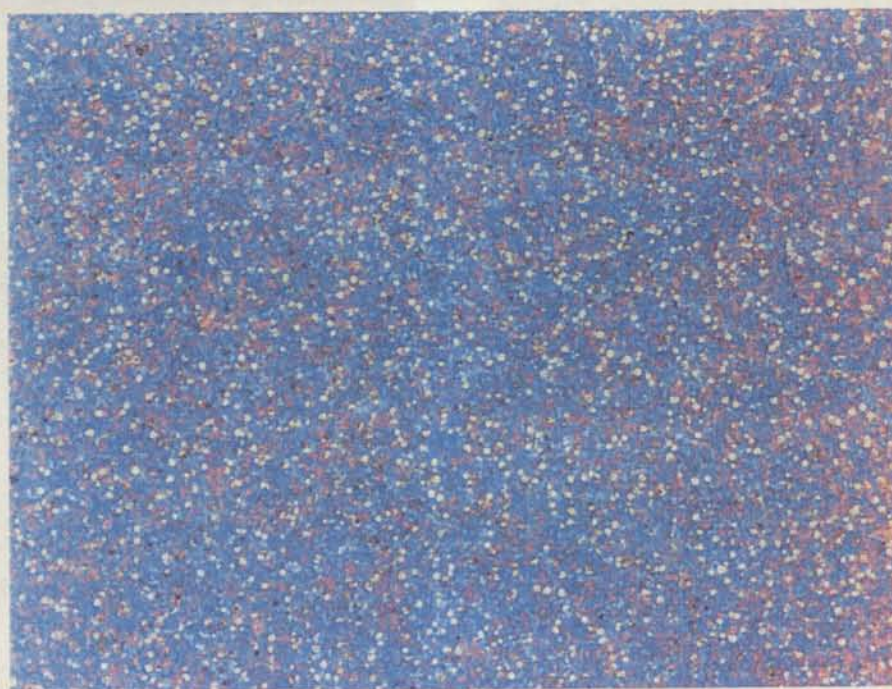
Figura 126 - Microestrutura dos ADICC para T_A 290°C: a) Nital 4% (x500) b) após coloração a quente (x100).
