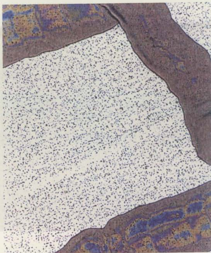
Figura 161 – Microestrutura típica das amostras de FNC observada nos cortes transversais dos tarugos: a) Periferia (x8) b) Mesma zona (x25). As áreas escuras da observação á lupa (x8) identificam as zonas da matriz de baixa densidade de nódulos.
