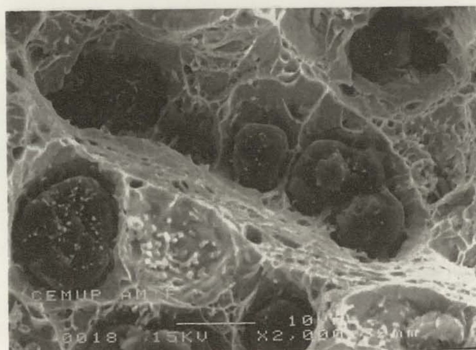
Figura 168 – Micrografias típicas realizadas por SEM nas superfícies de fratura das provetas de tração dos ADICC: a) T_A = 370^\circ\text{C} (x300) b) Outro local (x300) c) T_A = 345^\circ\text{C} (x300) d) Idem (x1500) e) Idem (x1500) f) T_A = 315^\circ\text{C} (x300) g) (x1500).
