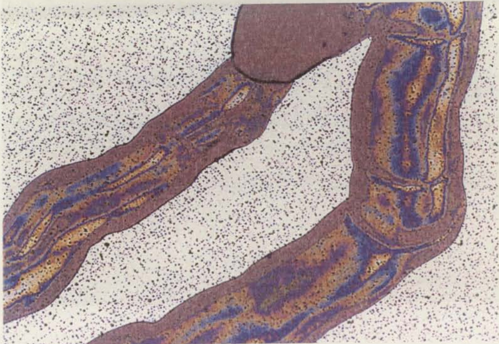
Figura 162 – Microestrutura típica das amostras de FNC observada nos cortes transversais dos tarugos: a) Centro (x8) b) Periferia (x8) c) e d) Mesma zona (x25). As áreas escuras da observação á lupa (x8) identificam as zonas da matriz de baixa densidade de nódulos.
