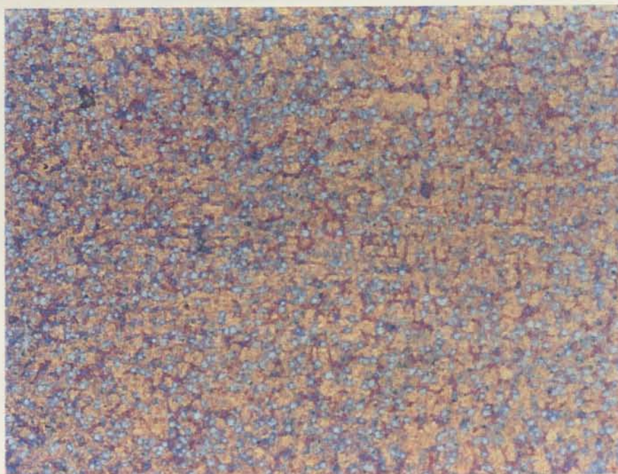
Figura 124 - Microestrutura dos ADICC para T_A 345°C: a) Nital 4% (x500) b) após coloração a quente (x100).
