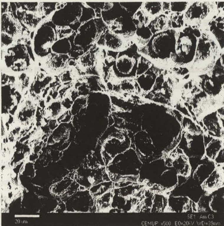
Figura 151 – Observação por SEM da superfície de fractura de um provete de FNC (Rm-474,9MPa e A-15,4%) com cadeias de nódulos muito próximos: a) e b) (x500).
