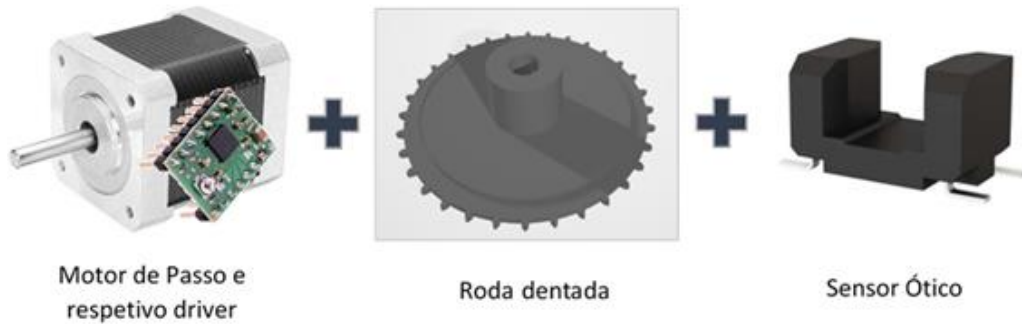
Figura 4.4 – Mecanismo de tração da fita e respetivo feedback
