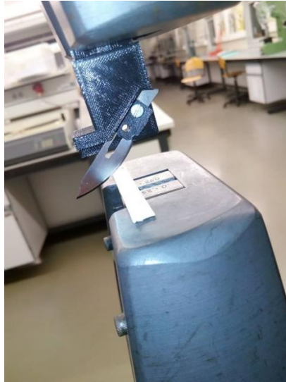
Figura 4.15- Teste de corte da fita de cartão
