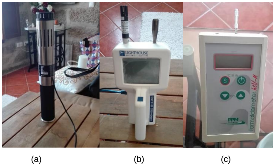
Fig.3.19 - Avaliação da qualidade do ar interior: (a) Sonda multiparamétrica (IQ-610 Qualityprobe); (b) Medidor de Partículas (Lighthouse 3016IAQ); (c) sensor de formaldeído htv-M
