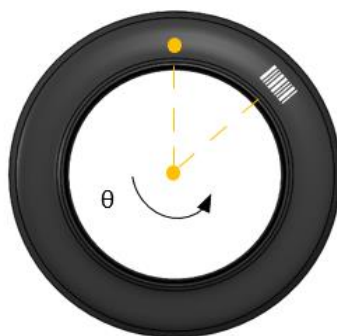
Figura 3.4 Esquema representativo da deteção de emendas em relação ao código de barras.
