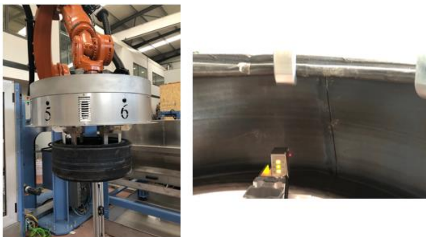
Figura 5.7 Condições para a rotação do pneu “em verde”, de forma a detetar uma emenda.
