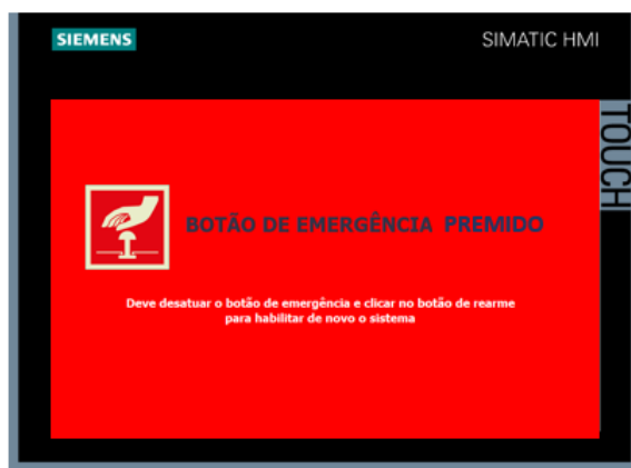
Figura 6.14 Ecrã de emergência.
