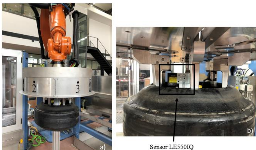
Figura 5.6 a) Condições para obter o perfil de um pneu “em verde” b) Posicionamento inicial dos sensores.
