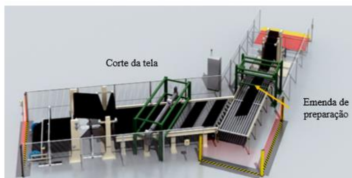
Figura 2.5 Representação do processo de corte das telas têxteis (SICK AG, 2019)
