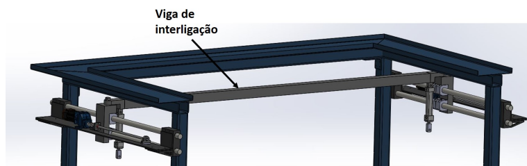
(a) Viga de interligação inserida no conjunto A
