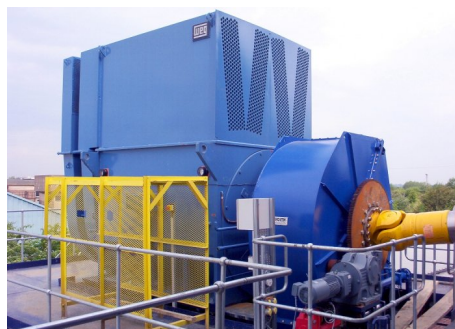
Figura 2.1 - Motor WEG utilizado no triturador LYNXS
