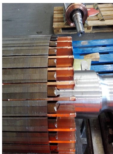
Figura 2.13 - Barras alinhadas com extremos a 50 mm da face do rotor
