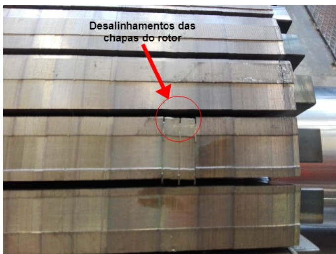
Figura 2.11 - Desalinhamentos nas chapas do rotor
