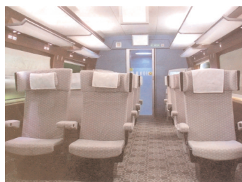
Fig. 53, 54: Interiores virtuais do KTX II 22 , comboio que será integralmente produzido na Coreia do Sul. O construtor será a Rotem e a operadora a empresa estatal coreana Korail. O design é da responsabilidade da MBD. Os bancos são rotativos permitindo que cada passageiro possa viajar no sentido da marcha, característica habitual nos comboios asiáticos.
