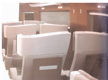
Fig. 53, 54: Interiores virtuais do KTX II 22 , comboio que será integralmente produzido na Coreia do Sul. O construtor será a Rotem e a operadora a empresa estatal coreana Korail. O design é da responsabilidade da MBD. Os bancos são rotativos permitindo que cada passageiro possa viajar no sentido da marcha, característica habitual nos comboios asiáticos.
