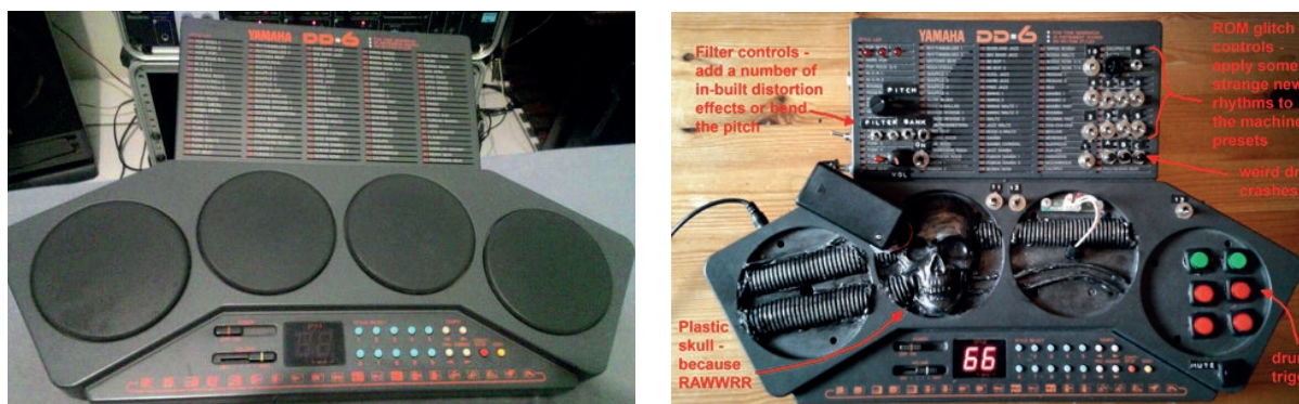
Fig. 20. Antes-e-depois de um dos processos de circuit bending , fonte desconhecida.
