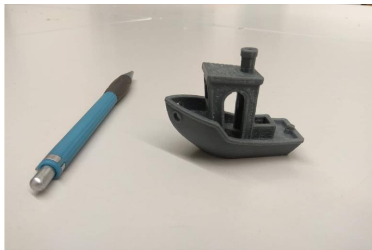
Figura 5.3 - Peça de teste impressa via cartão SD.
