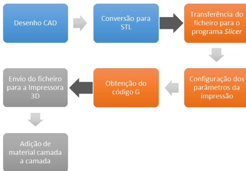
Figura 2.2 - Workflow do processo de Impressão 3D
