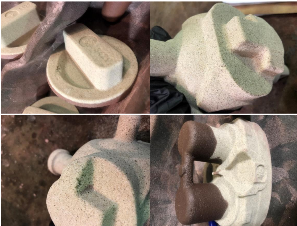
Figura 54 - Má compactação de diferentes machos devido à falta de escape de ar da caixa de machos.
