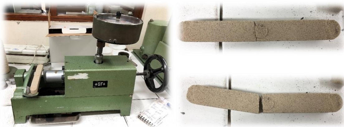
Figura 46 - Equipamento para o ensaio de flexão (à esquerda), e provetes após rotura (à direita).
