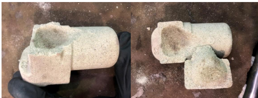
Figura 55 - Macho produzido a partir de um batch cuja mistura não ocorreu nas devidas condições.
