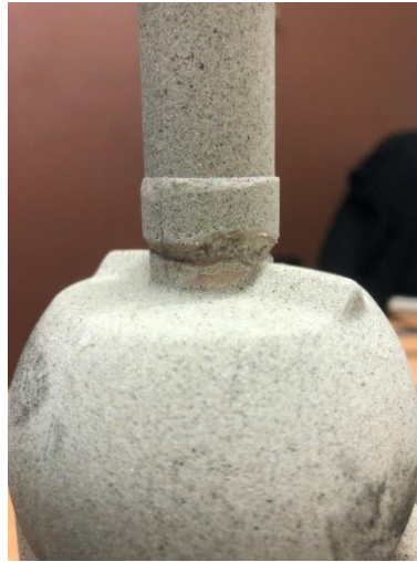
Figura 53 - Defeito no macho resultante da acumulação de sujeira na caixa de machos.
