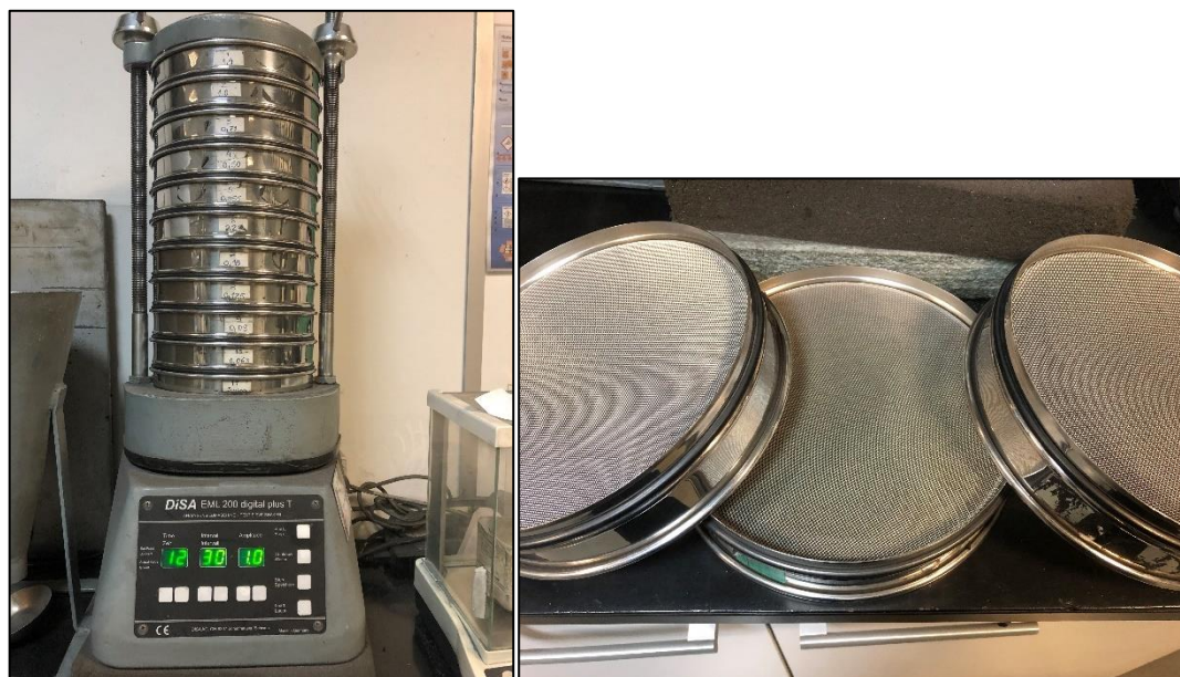
Figura 12 - Agitador de peneiros (à esquerda) e peneiros (à direita) para a análise granulométrica das areias.
