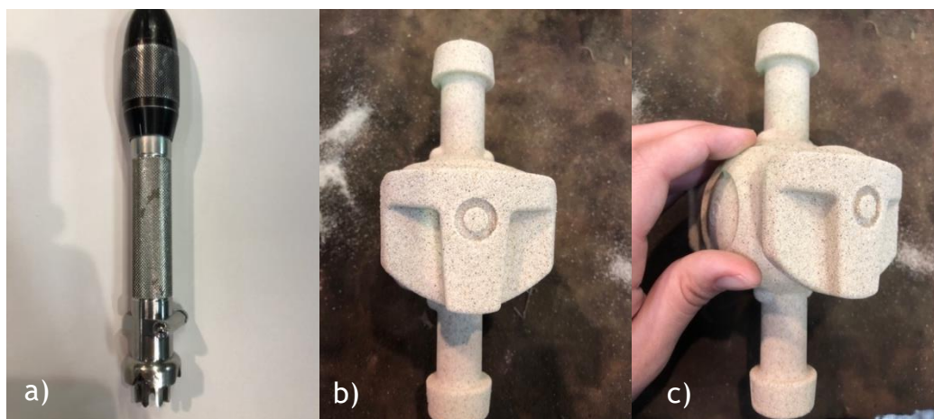
Figura 19 - a) Durômetro utilizado na determinação da dureza dos machos; b e c) um dos machos que foi alvo de ensaio de dureza.
