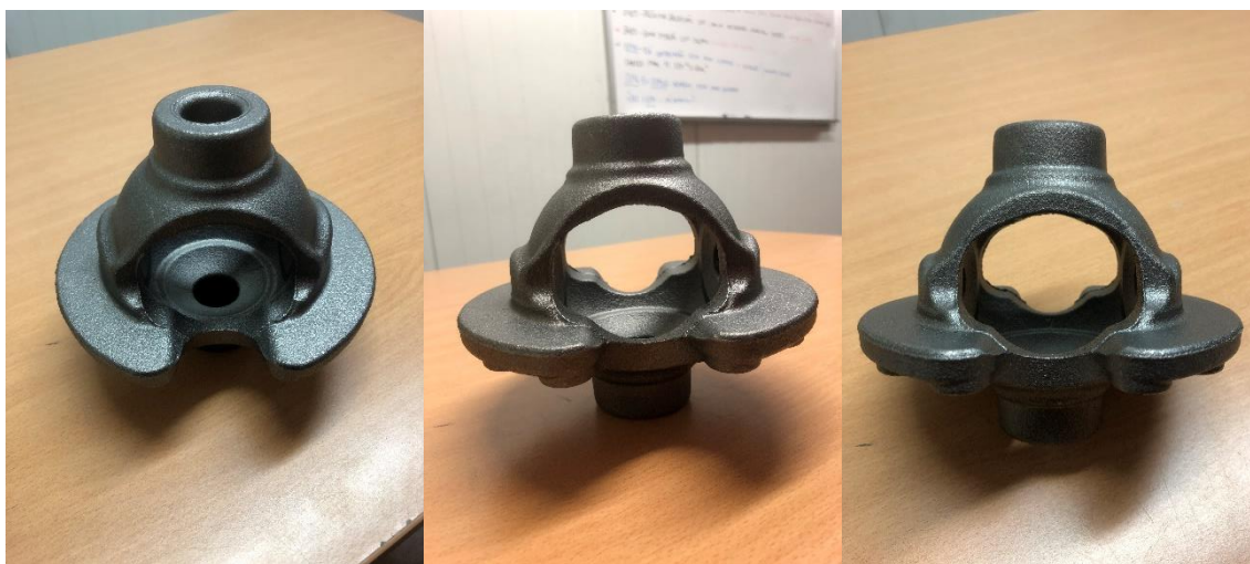
Figura 33 - Componente obtido no ensaio, em que foram utilizados machos da referência A produzidos segundo a condição 15.
