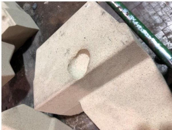
Figura 43 - Macho produzido utilizando uma elevada pressão de cura.
