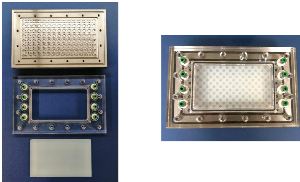
Figura 5 – Catalisador depositado na placa de vidro de borossilicato do NETmix.
