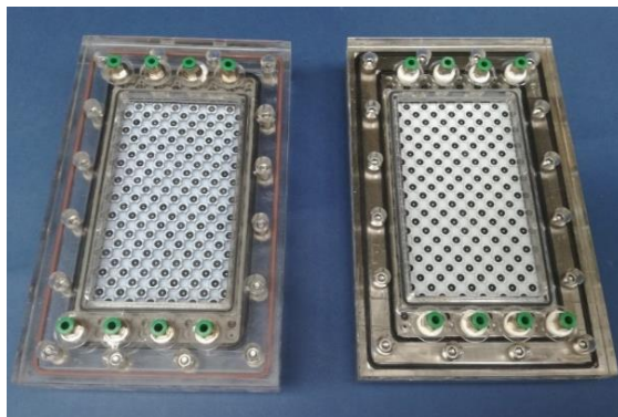
Figura 6 – Catalisador depositado nos canais e câmaras do NETmix com 3 mm e 1 mm de profundidade, respetivamente.
