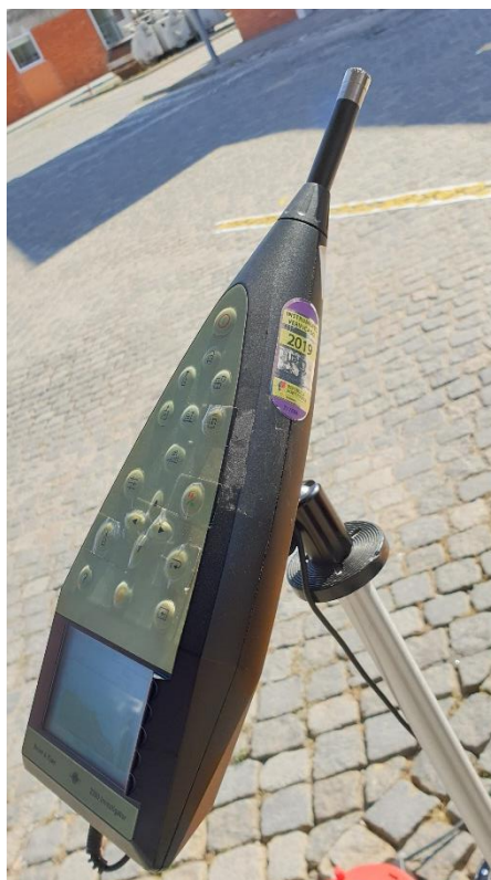
Figura 38 - Sonómetro B&K 2260, usado nos ensaios experimentais das instalações da CMM
