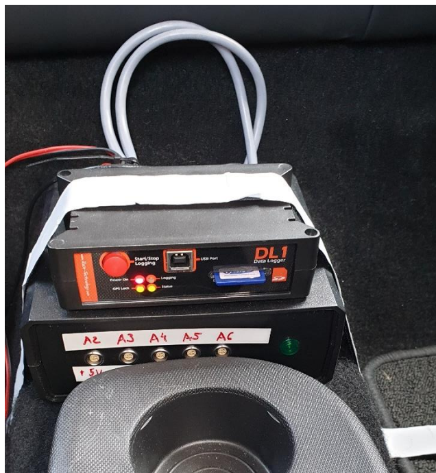
Figura 43 - DL1 (Data Logger) da Race Technology, colocado no centro do veículo
