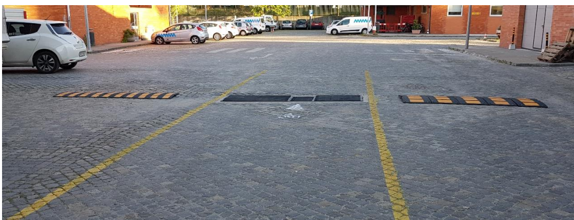
Figura 42 - Três desnivelamentos verticais usados nos ensaios experimentais: LRV de 3 cm, sistema PEH e LRV de 5cm (da esquerda para a direita)
