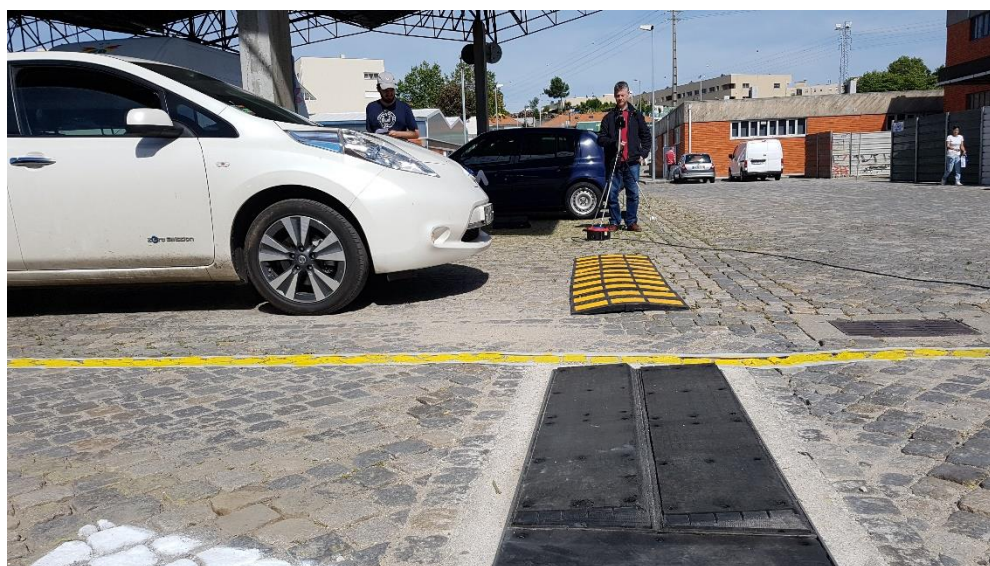
Figura 41 - Ensaio de Medição do nível de ruído, com O Nissan Leaf , a passar sobre a LRV de 3 cm
