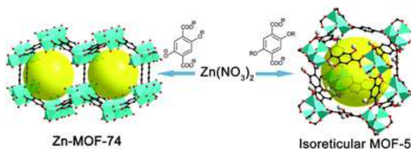
Figura 1.5. Exemplo da influência da seleção de um determinado conjunto de unidades de construção na estrutura do MOF. [42].
