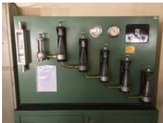
Figura 22 - Cyclosizer pertencente ao Departamento de Minas - FEUP
