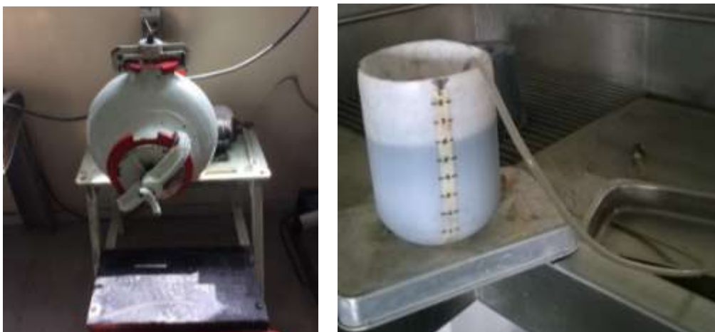
Figura 30 - Moinho de bolas e processo de desenlameamento
