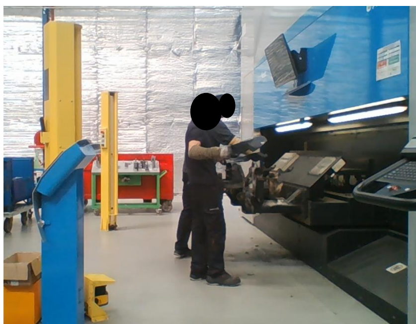
Figura 118 – Retirada e colocação da peça menor da célula a laser .
