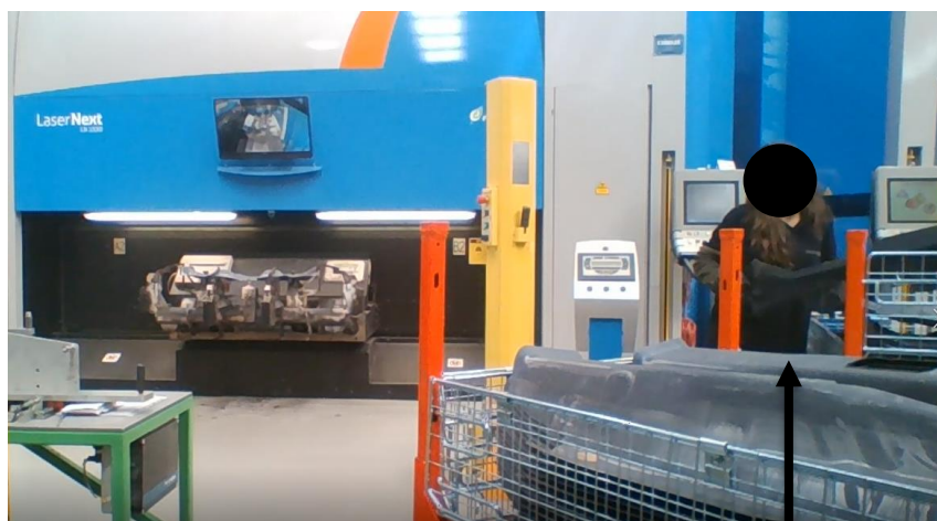
Figura 113 – Carregamento da peça menor do contentor à mesa a laser .
