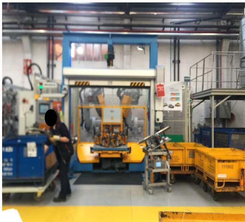
Figura 45 – Trabalhador a retirar a peça para ser soldada.
