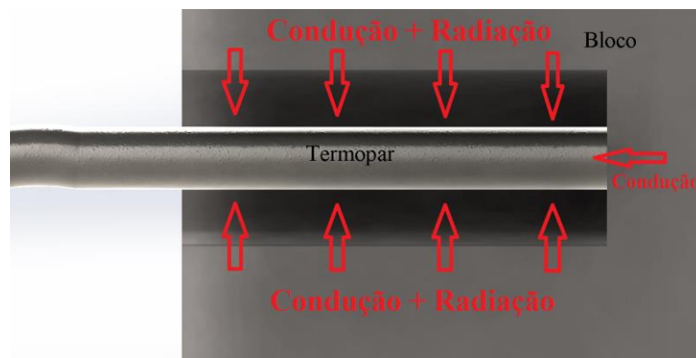
Figura 3.3 - Mecanismos de transferência de calor entre os furos do bloco e os termopares.
