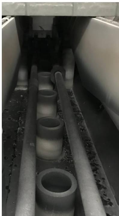
Figura 1.7 - Representação das resistências de grafite, através das quais o forno é aquecido.
