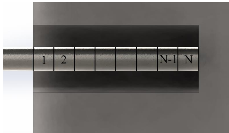
Figura 3.4 - Numeração das secções constituintes do termopar, exemplo da divisão do termopar em 8 elementos.
