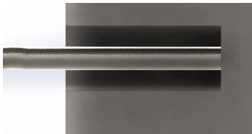
Figura A.3 - Situação ideal e simulada de contacto entre os termopares e os furos utilizados para as medições de temperatura.
