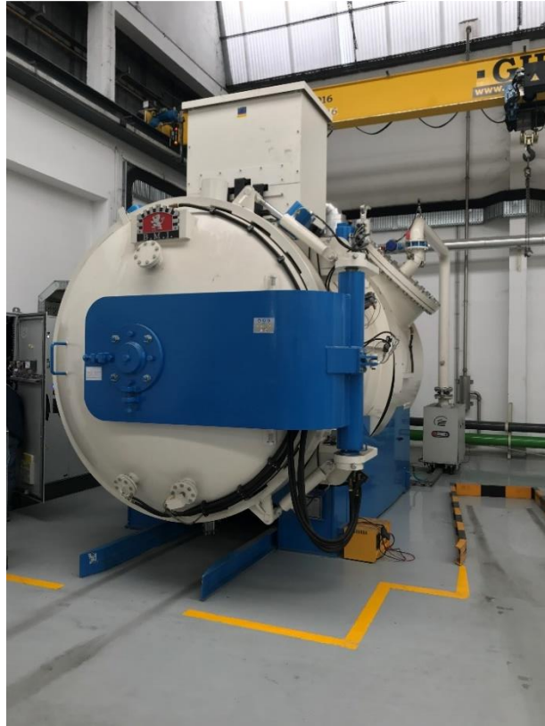
Figura 1.3 - Forno utilizado nos ensaios de têmpera.
