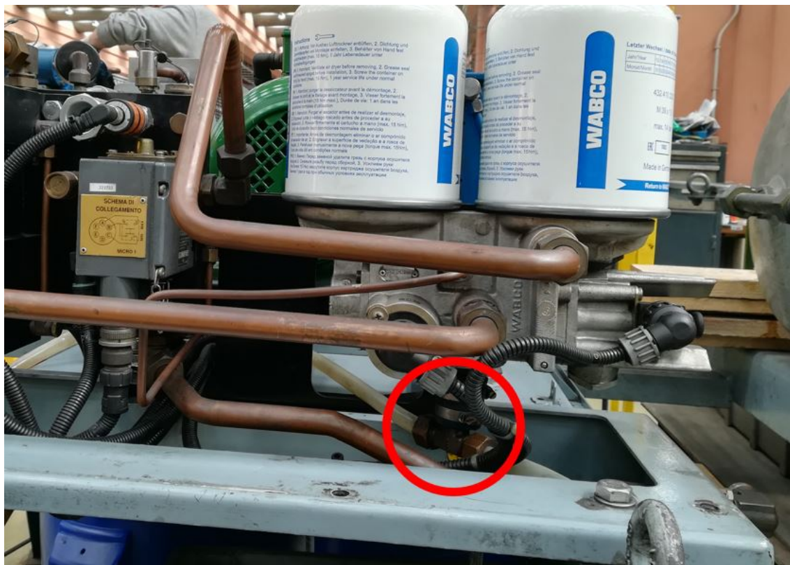
Figura 5.10: Local onde será colocado o transdutor de pressão que monitoriza a descarga das torres secadoras de ar.
