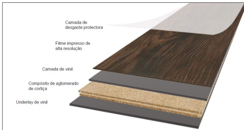
Figura 5 - Wood Hydrocork : estrutura de produto que contém LVT (camada de desgaste protectora + filme impresso de alta resolução + camada de vinil)
