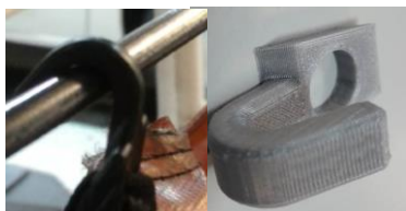
Figura 29 – Gancho original e impresso
