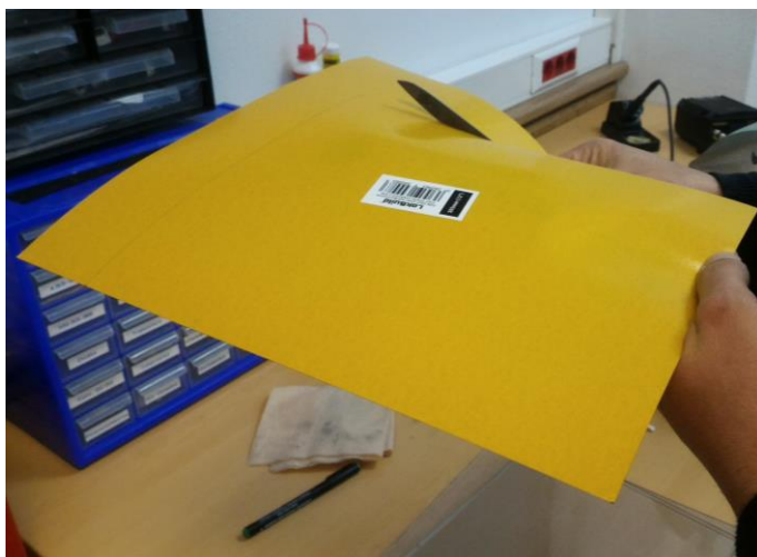
Figura 38 – Recorte da superfície de Impressão LokBuild e aplicação na cama de impressão
