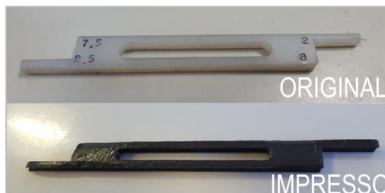
Figura 26 - Cale Original e Cale Impressa em PLA
