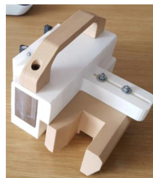
Figura 27 - Calibre para regulação de escovas limpa vidros impresso em 3D
