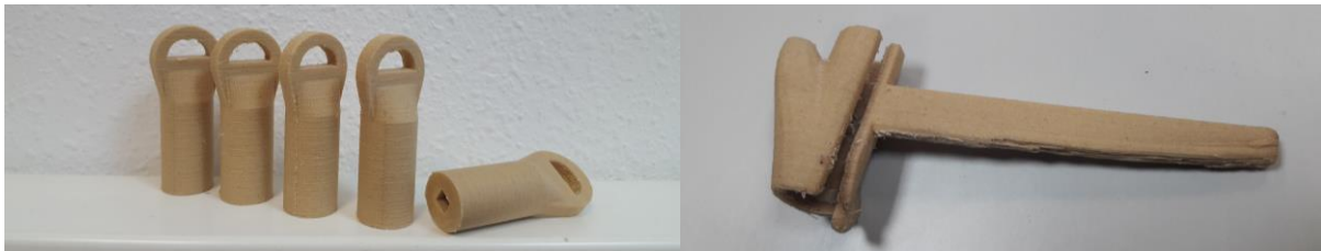
Figura 6 - Exemplos de peças impressas em Wood PLA
